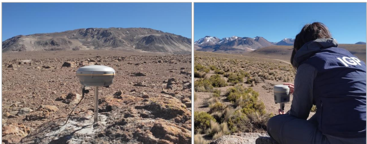
Figura 4.6. Instalación de equipos GNSS para monitoreo de volcanes Purupuruni y Casiri.
