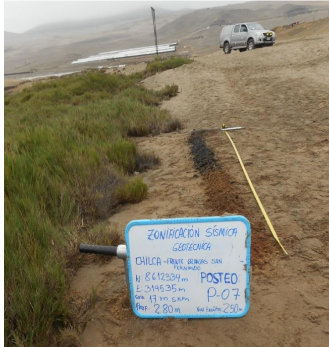
Figura 33: Elaboración del posteo P-07, ubicado frente a las granjas San Fernando.
