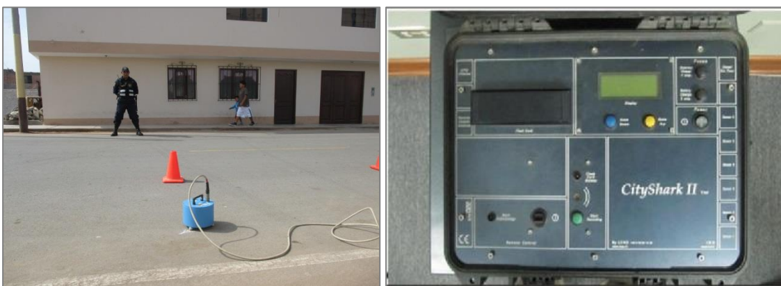
Figura 5: Equipo sísmico utilizado para el registro de vibraciones ambientales en Chilca: sensores Lennartz (2N) y registrador CityShark II
