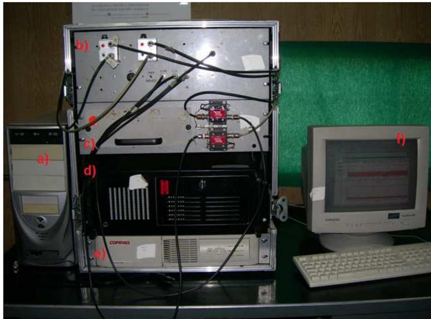
**Figura 4.6.** Disposición de los equipos para la recepción en Paracas. a) Computadora de adquisición empleada en las pruebas, b) Desacopladores de DC de los pre-amplificadores de campo, c) Pre-amplificadores, d) Computadora de adquisición empleada en el sistema del radar biestático, e) UPS, f) Visualización en tiempo real de la señal recibida.
