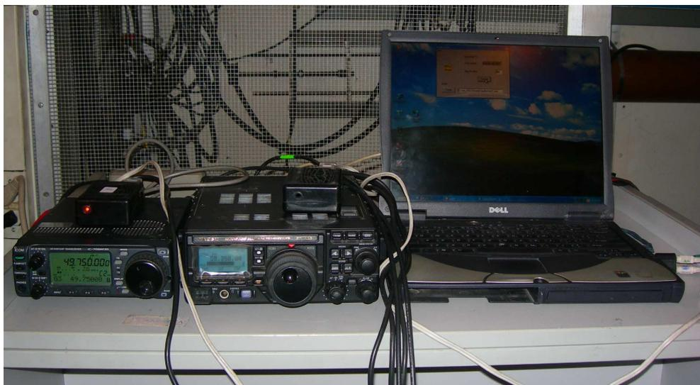
**Figura 4.4.** Disposición de los equipos para la transmisión empleando diversidad en frecuencia. La misma señal se transmite a través de dos radios operando a frecuencias distintas.
