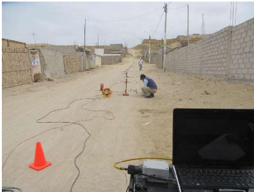
Figura 9: Imagen de la disposición del equipo de refracción sísmica en la ciudad de Camaná
