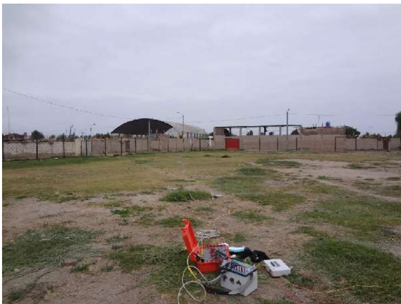
Figura 10: Imagen de disposición del equipo de prospección eléctrica para la toma de datos en la ciudad de Camaná
