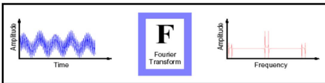
Figura 4.4.- Esquema de la transformada de Fourier.
