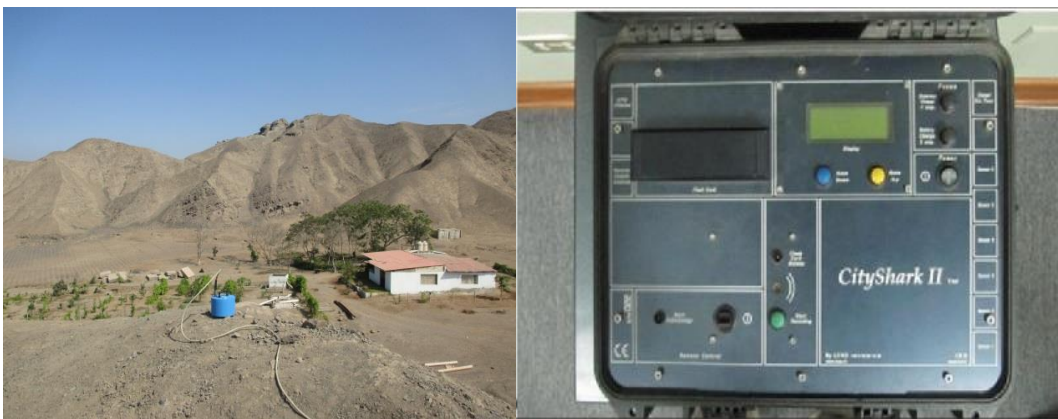
Figura 5: Equipo sísmico utilizado para el registro de vibraciones ambientales en la ciudad de Nuevo Imperial: sensor Lennartz (2N) y registradores CityShark II.
