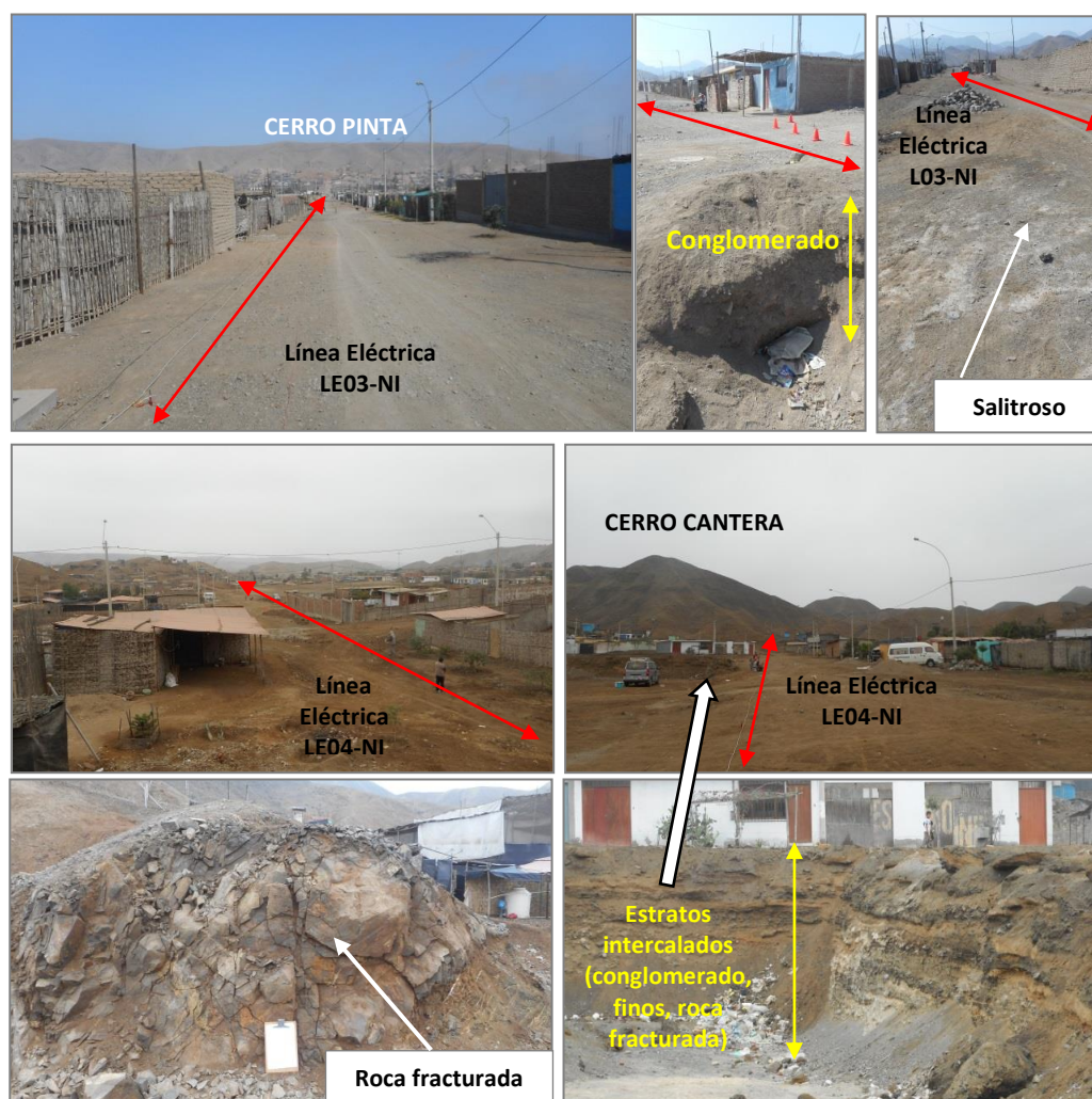
Figura 19: Vista de las líneas LE03-NI y LE04-NI compuesto por roca fracturada
