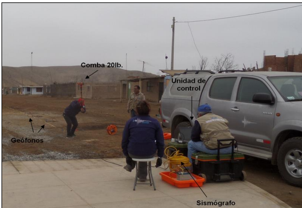
Figura 8: Equipos utilizados en la toma de datos de MASW realizado en la zona el Desierto.
