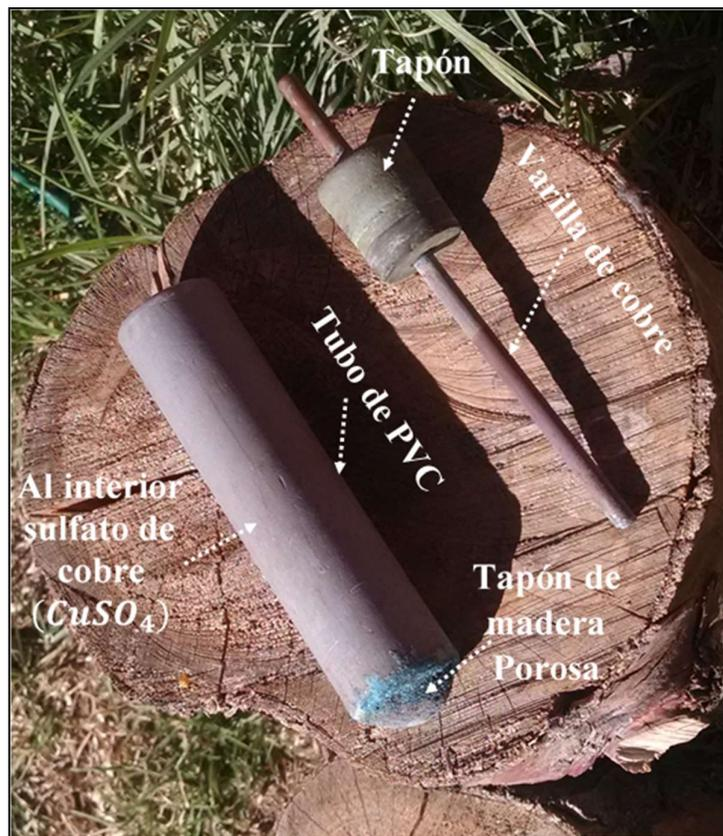
Figura 4.2: Diseño y construcción de un electrodo Impolarizable.
