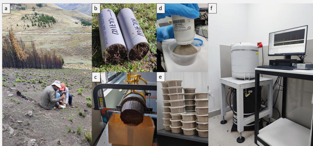
Figura 3.2.2. Proceso (a) extracción de testigos, (b) testigos de suelo compuesto, (c) laminado de testigos, (d) acondicionamiento de muestra, (e) muestras acondicionadas y (f) medición de muestras por espectrometría de rayos gamma.
