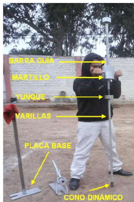
Figura 7: Equipos, accesorios y técnica de DPL
