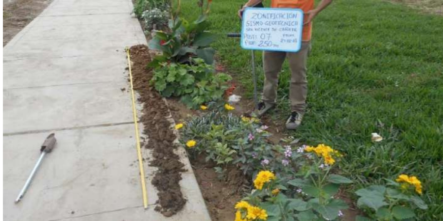
Figura 6: Posteadora y muestras obtenidas en suelos de San Vicente de Cañete
