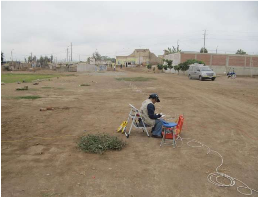
Figura 12: Disposición del equipo de prospección eléctrica en la ciudad de Cañete
