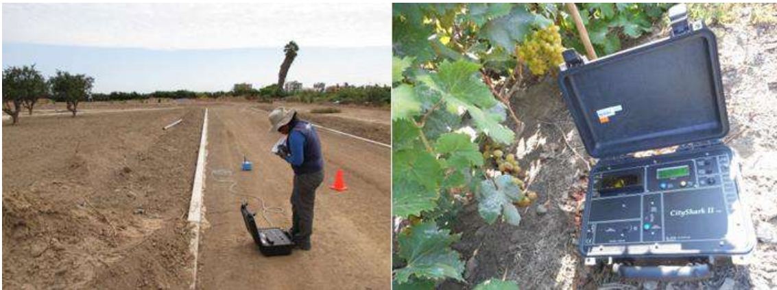
Figura 8: Equipo sísmico utilizado para el registro de vibraciones ambientales en San Vicente de Cañete: sensores Lennartz (2N) y registrador CityShark
