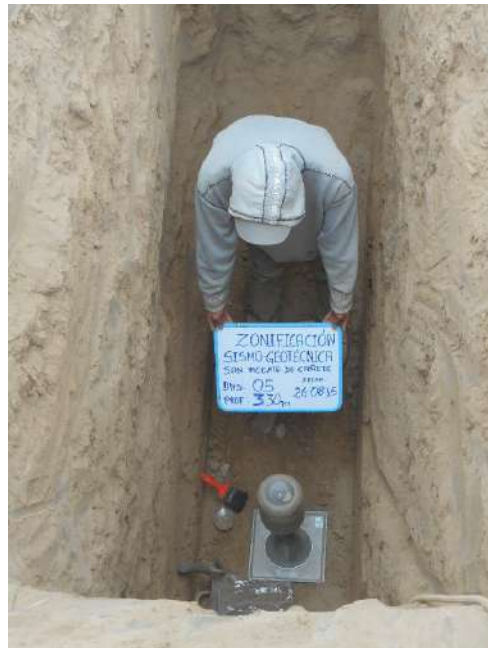
Figura 5: Calicata elaborada en San Vicente de Cañete y ensayo de densidad de suelo mediante el método del Cono de Arena.
