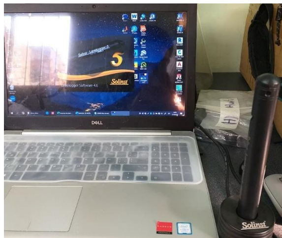
Figura 32: Descarga de información de niveles de agua del Levelogger a PC
