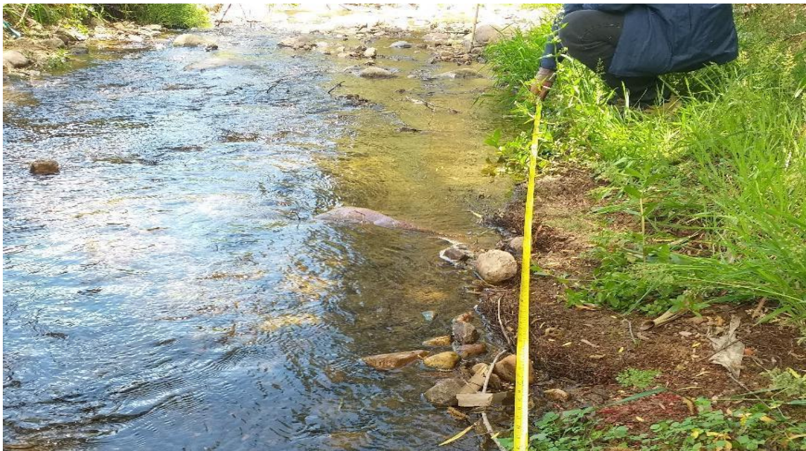
Figura 24: Recolección de información de tiempo y distancia en que los flotadores recorren los 2 puntos de referencia
