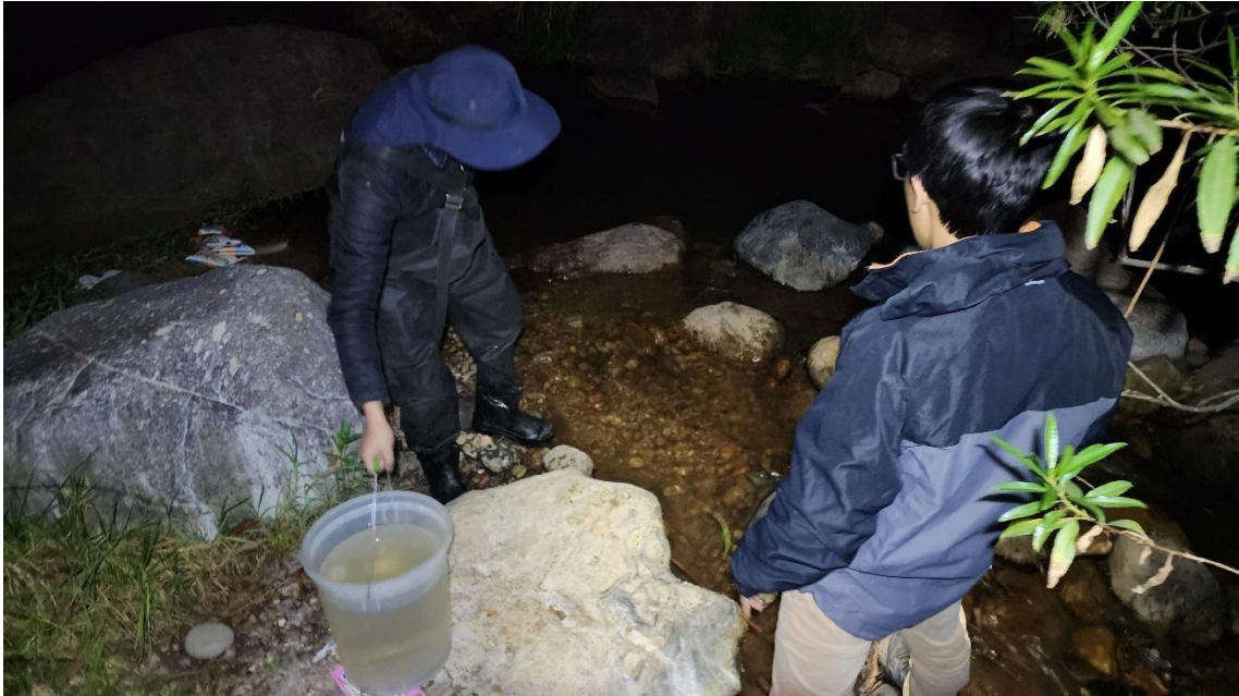
Figura 18: Búsqueda de zonas turbulentas aguas arriba para vertimiento de la solución salina
