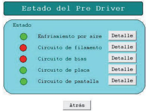
Figura 7: Pantalla que permite visualizar con mayor detalle el estado de los circuitos de la etapa seleccionada del transmisor.
