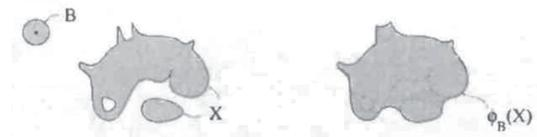
Fig 2. Aplicación de la operación de cerradura morfológica al objeto B usando el elemento estructurante X. A la izquierda se muestran X y B, y a la derecha el resultado.
