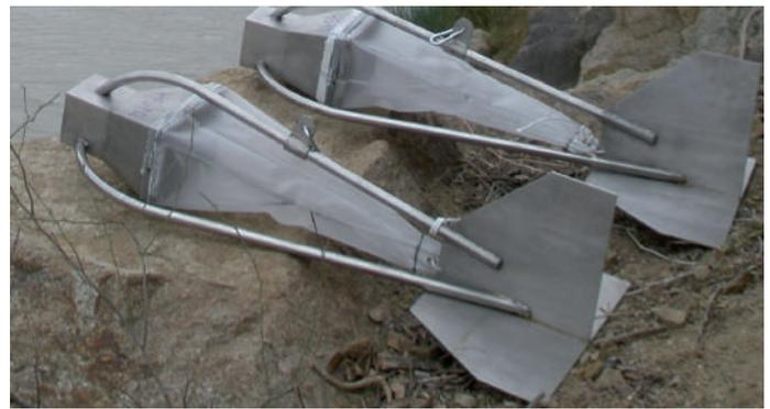
Figura 4. Muestreador de fondo Helley-Smith. Se contó con dos prototipos.
