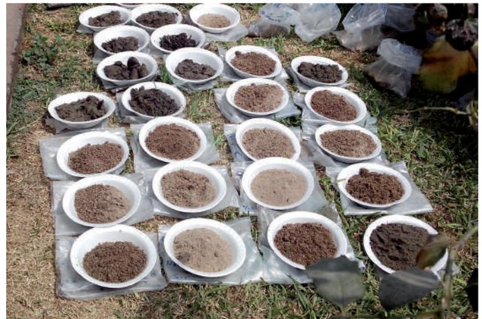
Figura 5. Secado al ambiente de muestras de sedimento de fondo.
