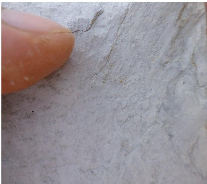
Figura 05: Arcilla formada por la alteración de las pizarras en el localidad del Kellcaybamba.
