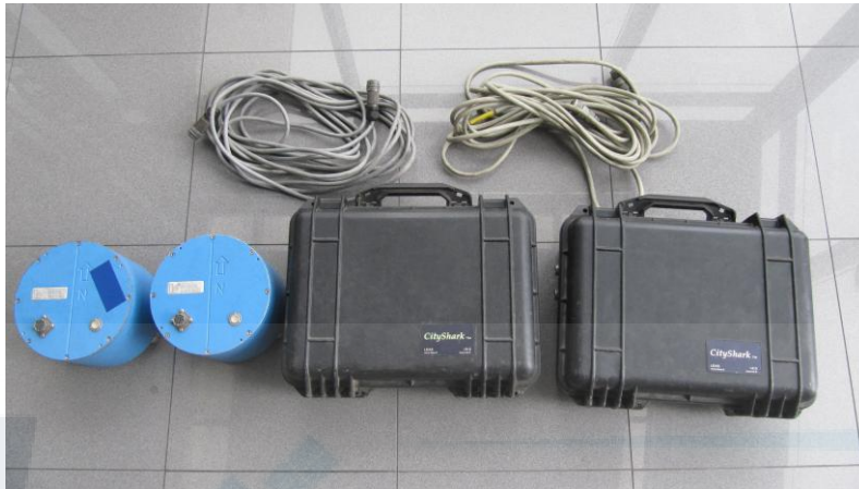
Vista de los sensores y registradores
