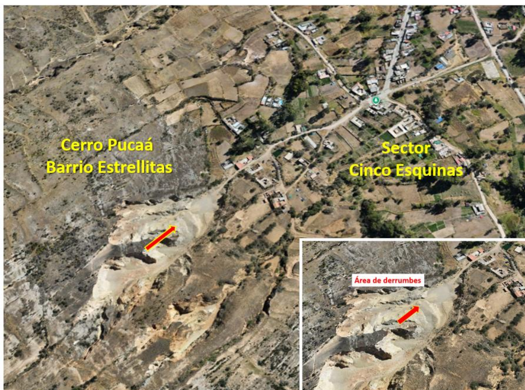
Figura 26.- Ubicación geográfica del Cerro Pucaá en Barrio Estrellita y ruta de acceso desde el Sector Cinco Esquinas. La flecha de color rojo indica la ubicación del área de suelos inestables y la dirección que siguen los derrumbes, y flujos en temporadas de lluvias.
