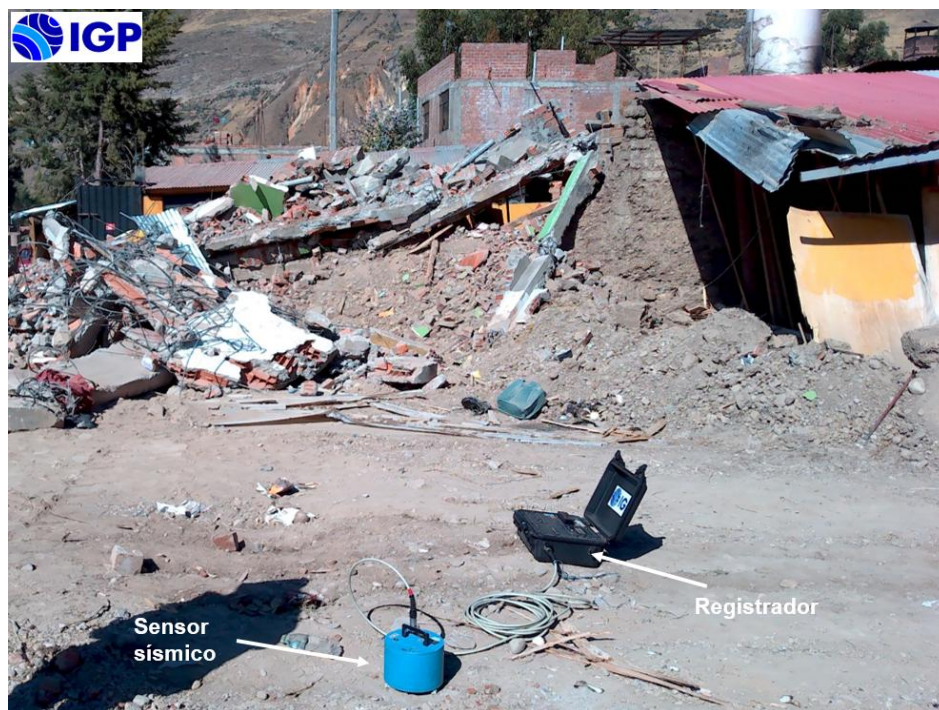
Figura 53. Equipo sísmico utilizado para el registro de vibraciones ambientales: sensor Lennartz (2N) y registrador CityShark II.
