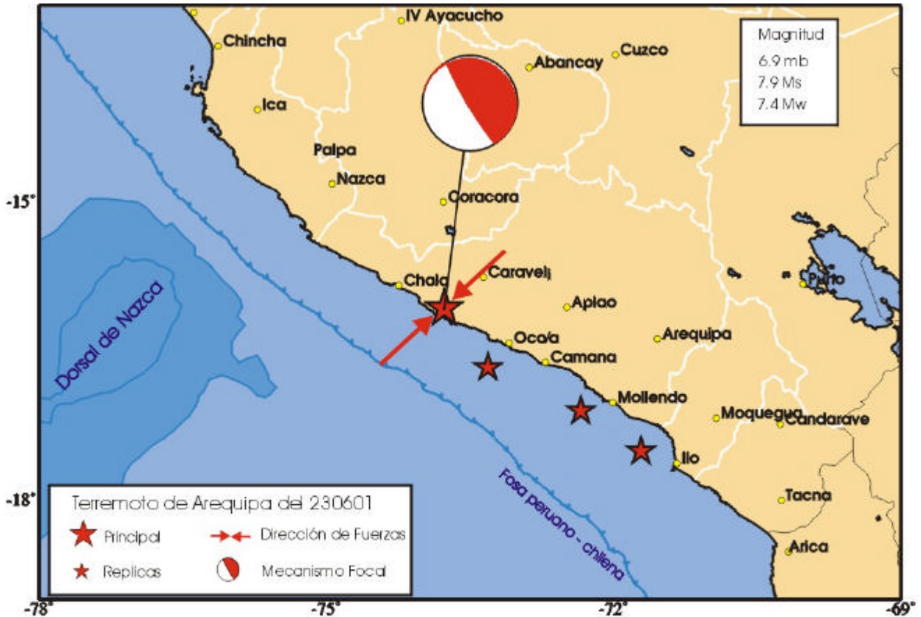
Figura 5. Mecanismo Focal y orientación del esfuerzo principal que dio origen al terremoto de Arequipa del 23 de Junio de 2001. Se indica la ubicación de 3 replicas principales y los valores de magnitud en diferentes escalas.
