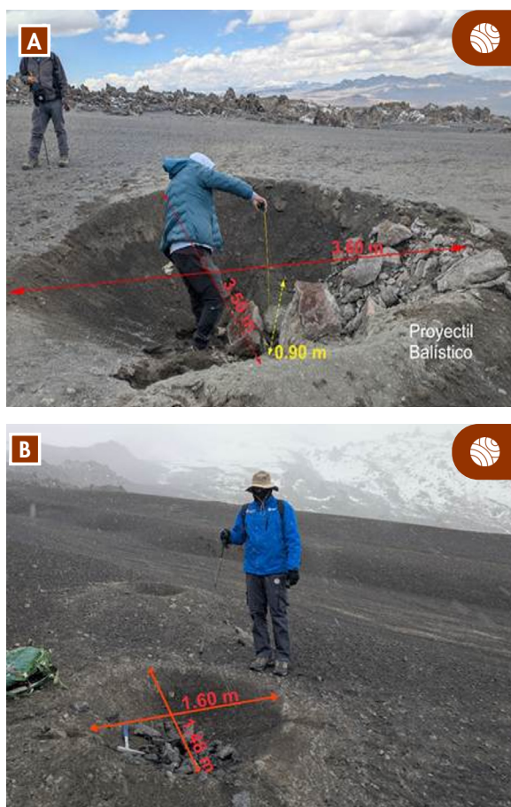
Figura 16. Bloques balísticos eyectados durante la explosión del 13 de septiembre de 2025: (a) bloque de hasta 0.90 m de diámetro que generó un cráter de impacto de 3.6 m de diámetro, localizado a 2.1 km al sureste del cráter; (b) cráter de impacto de 1.6 m de diámetro, a 2 km del cráter, en el flanco sureste.
