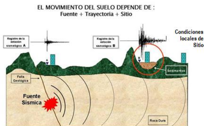
Figura 6: Las condiciones locales de sitio controlan la amplificación del sacudimiento del suelo, puesto en evidencia con la amplitud del registro sísmico obtenido sobre roca y sedimentos.
