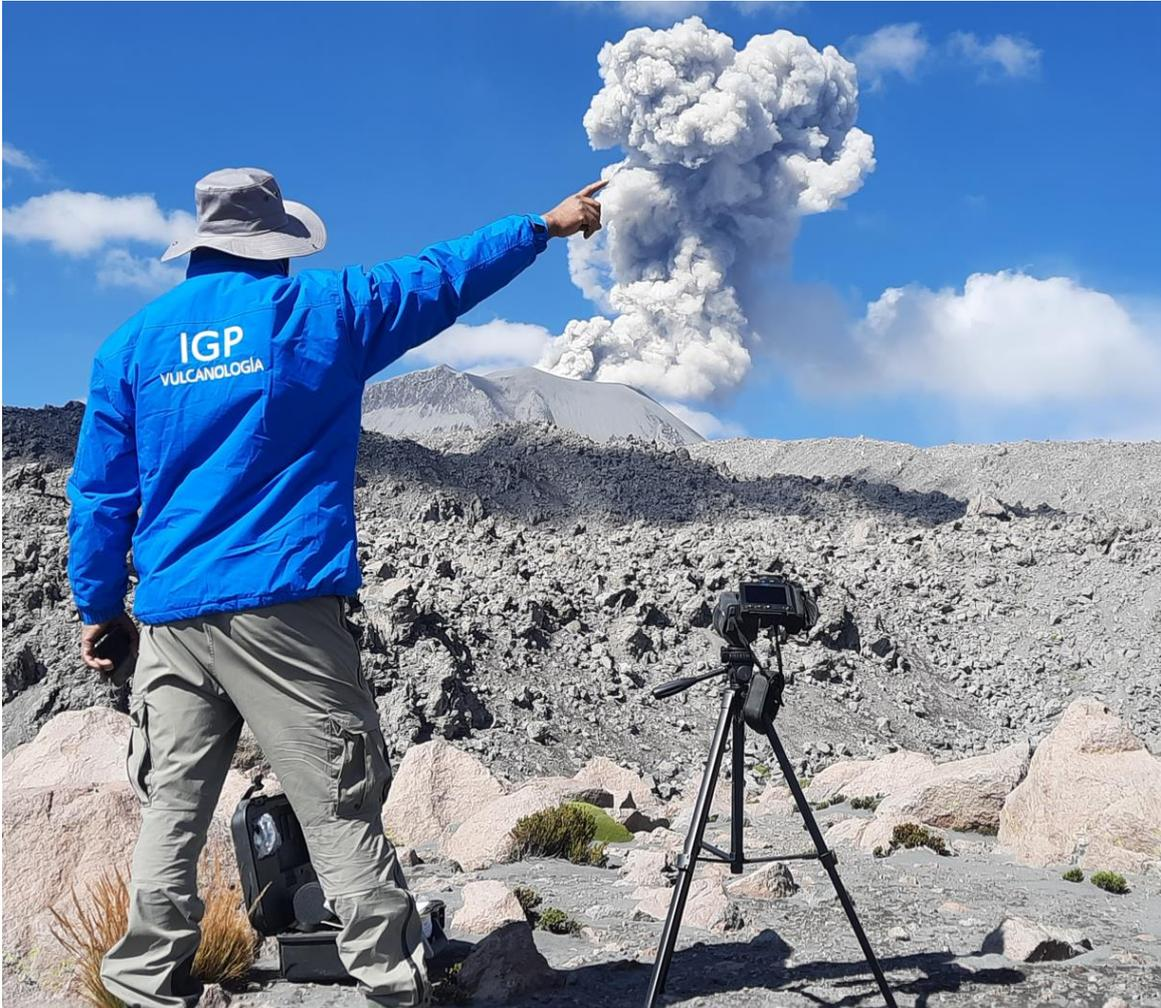
*Figura 8.- Cámara FLIR instalada al noreste del volcán Sabancaya para la observación de emisiones térmicas.*
