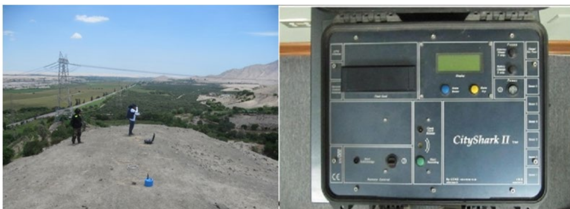
Figura 5: Equipo sísmico utilizado para el registro de vibraciones ambientales en Humay: sensores Lennartz (2N) y registrador CityShark II.
