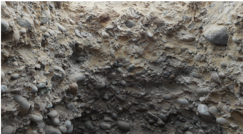
Figura 14: Los materiales observados hasta 3 m de profundidad muestran capas bien compactas de gravas con matriz arenosa.
