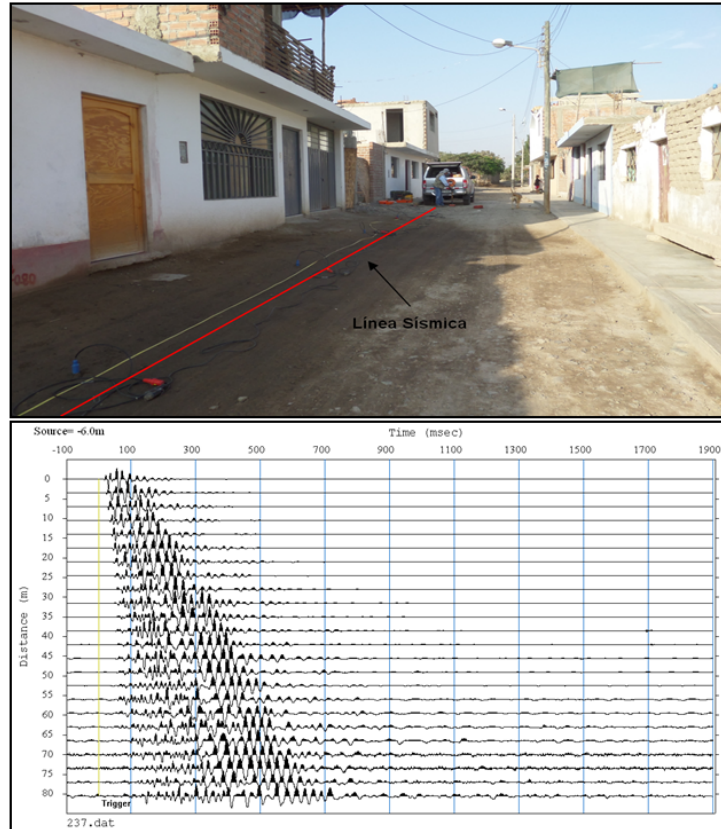
Figura 11: Disposición del equipo de adquisición por el método de MASW y el registro sísmico obtenido.
