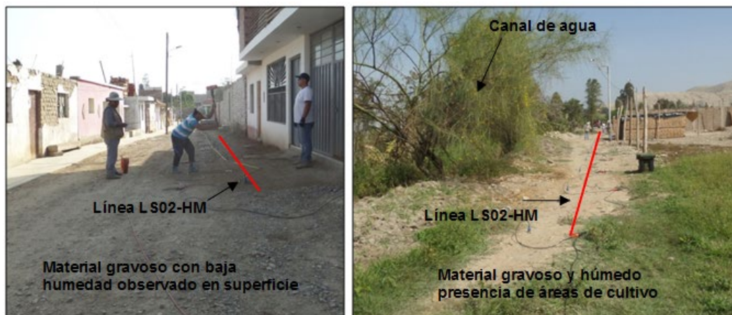
Figura 19: Ensayo sísmico realizado en la zona urbana de Humay: capa superficial constituida por suelos moderadamente duros (LS02-HM y LS03-HM).
