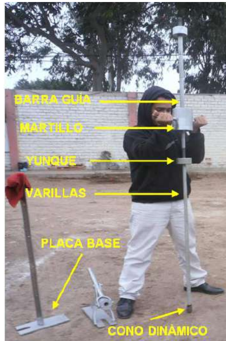
Figura 8: Equipos, accesorios y técnica de DPL
