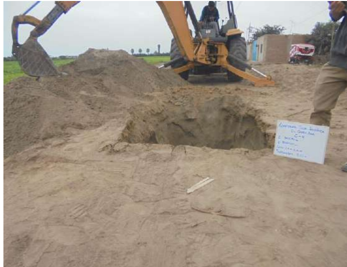
Figura 6: Calicata elaborada en el sector Bellavista, a 1 km el Este del centro urbano de Cerro Azul.
