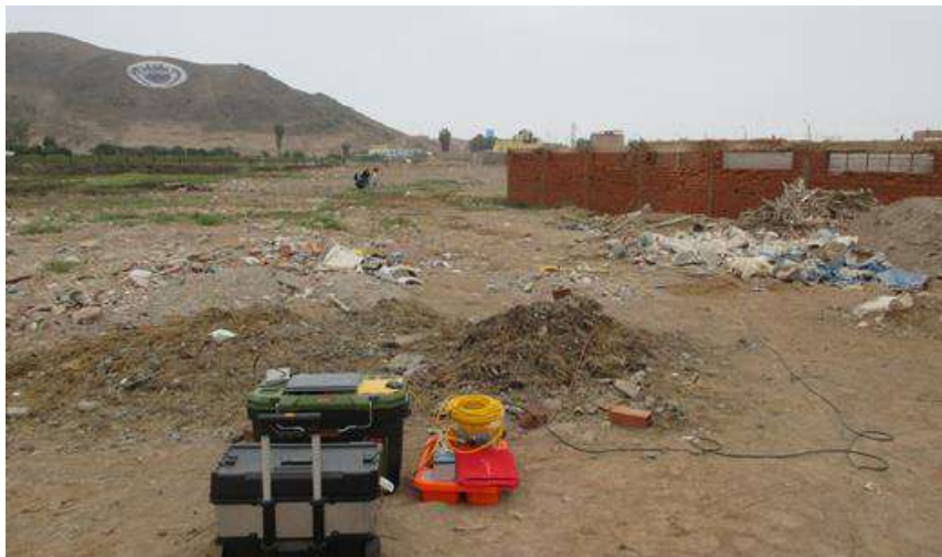
Figura 50: Observaciones y recolección de datos sísmicos en la ciudad de Cerro Azul sobre suelos con alto contenido de humedad
