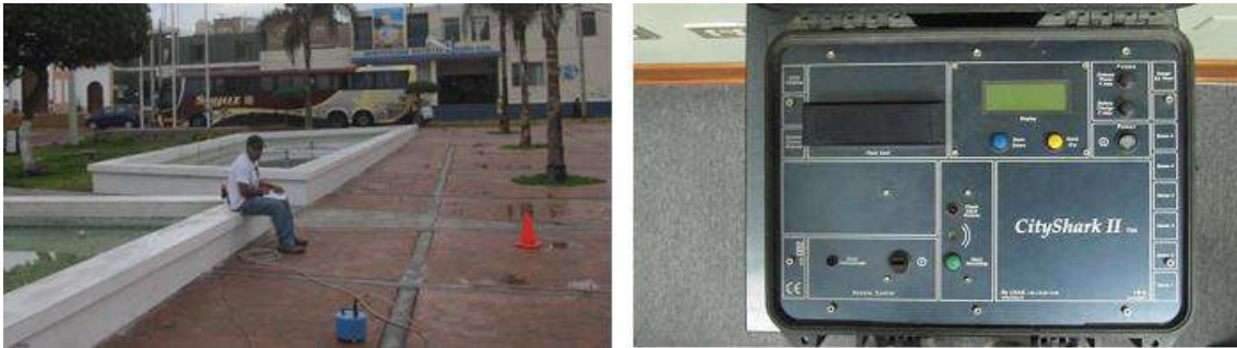
Figura 9: Equipo sísmico utilizado para el registro de vibraciones ambientales en Cerro Azul: sensores Lennartz (2N) y registrador CityShark
