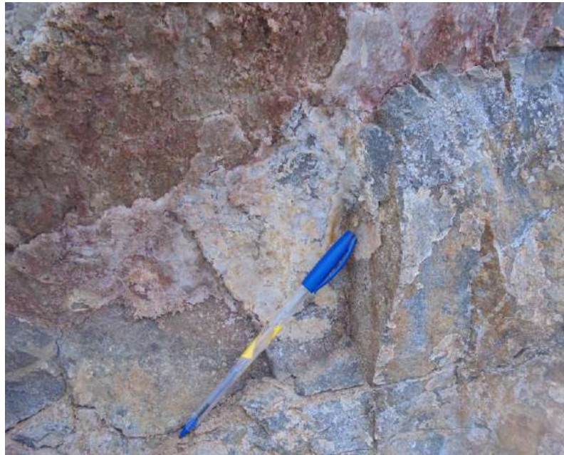
Figura 37: Rocas intrusivas del tipo diorita de la unidad Superunidad Linga, sector Colina Blanca.
