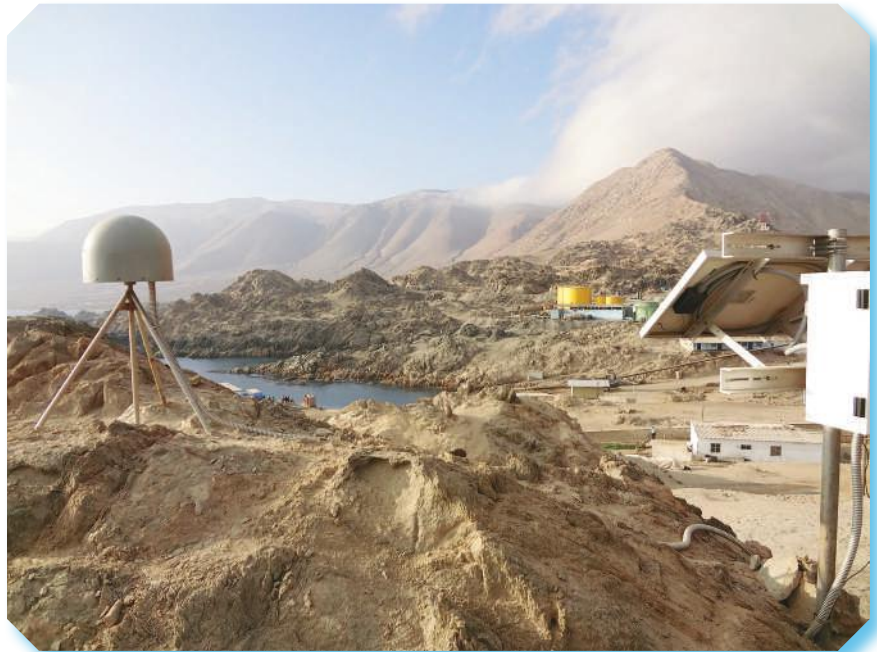
Vista de estación GPS en Atico-Arequipa. Pertenece a la red IGP-Caltech y su registro de datos es continuo a velocidades de 15 y 0,2 segundos
