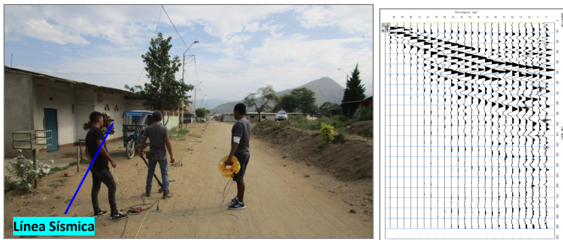
Figura 8: Disposición del equipo de adquisición de registro sísmico.
