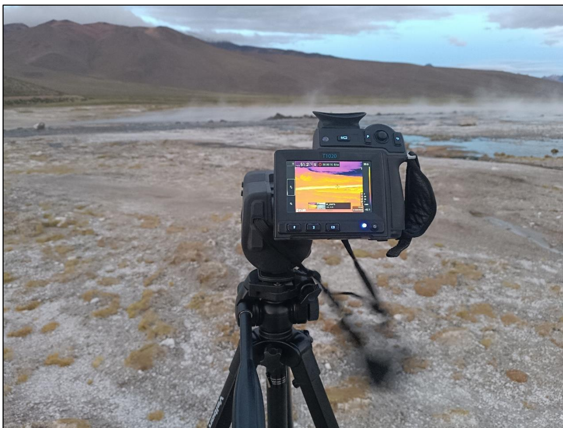
Figura 20. Instalación de la cámara FLIR en una zona de fuentes termales al norte del volcán Purupuruni.
