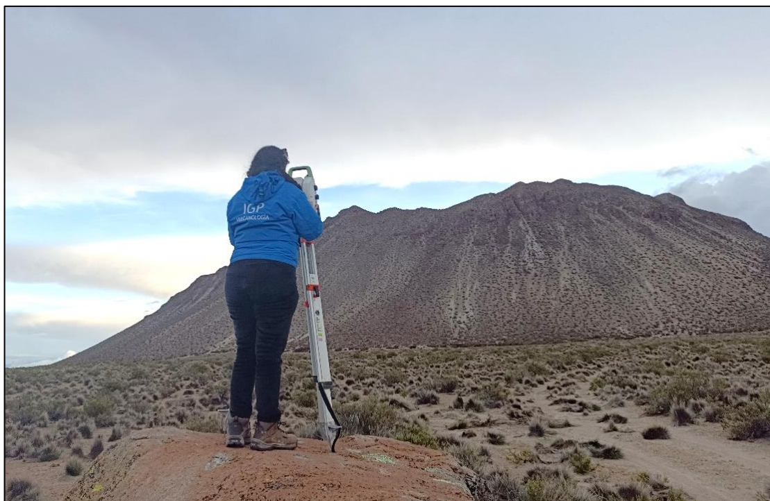
Figura 19. Instalación de la estación total temporal del IGP en el volcán Purupuruni.
