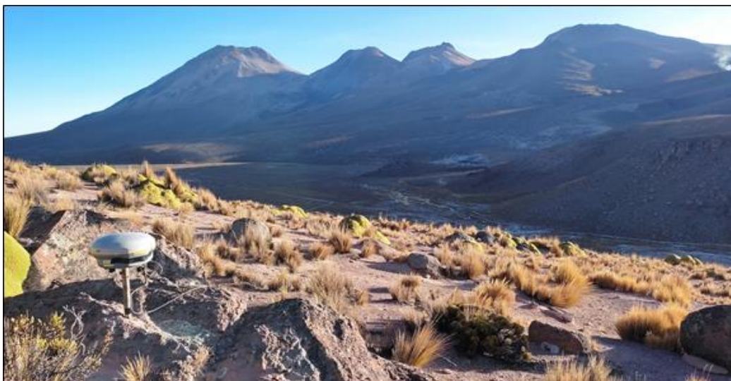
Figura 10.- Instalación de GNSS temporal en el volcán Yucamane.
