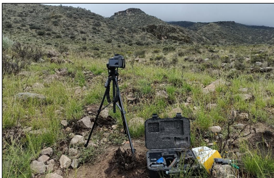
Figura 11.- Instalación de cámara FLIR en el volcán Yucamane.
