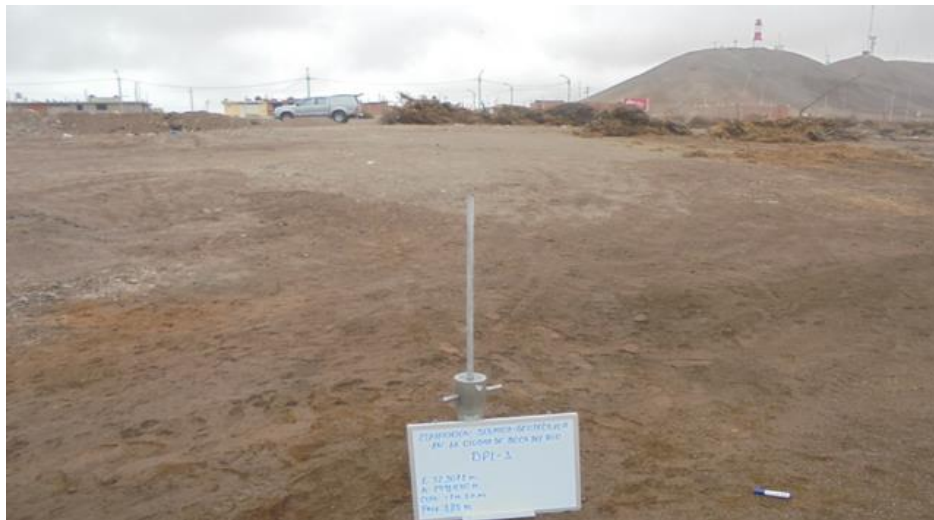
Figura 37: Ensayo de penetración dinámica ligera (DPL-5).
