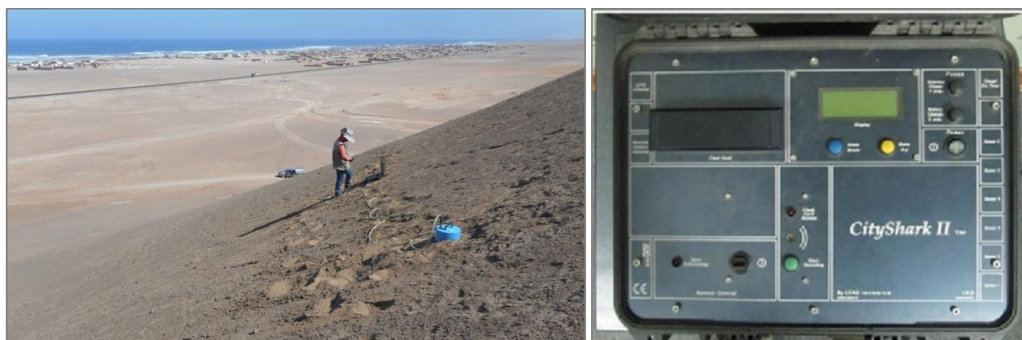
Figura 6: Equipo sísmico utilizado para el registro de vibraciones ambientales en Boca del Río: sensor Lennartz (2N) y registrador CityShark II.
