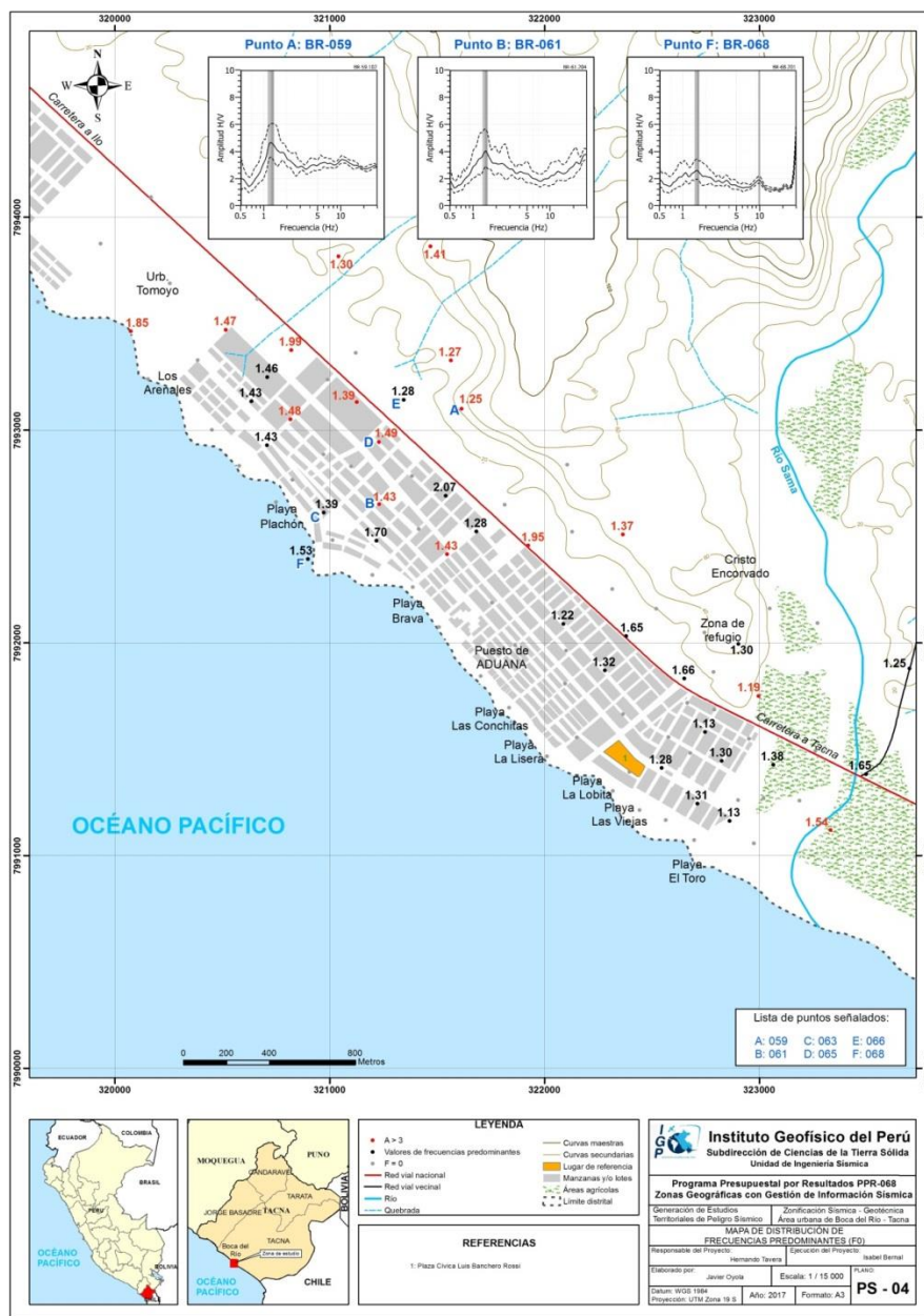
Figura 15: Mapa del área de estudio con la distribución espacial de las frecuencias predominantes F_0 ( F \leq 2.0 Hz) definidas en cada punto. Las letras indican la ubicación de los gráficos de la Figura 15.
