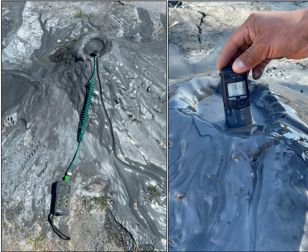
Figura 6.- Medición de temperatura con termómetro Hanna (izquierda) y con equipo multiparámetro (derecha).
