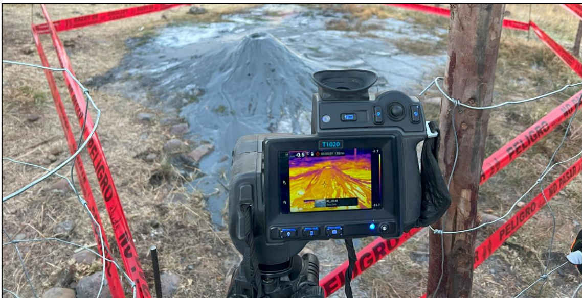
Figura 5.- Adquisición de imágenes térmicas de la zona de estudio con cámara FLIR.
