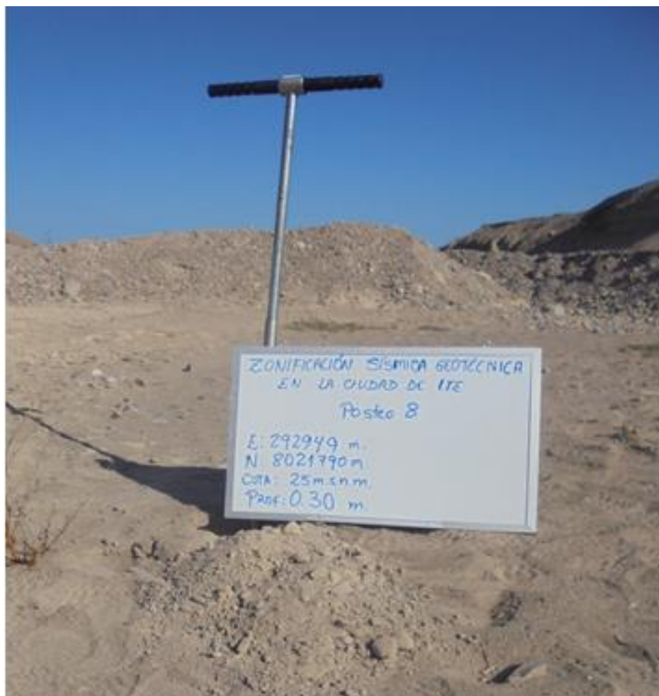
Figura 36: Ensayo con posteadora manual.
