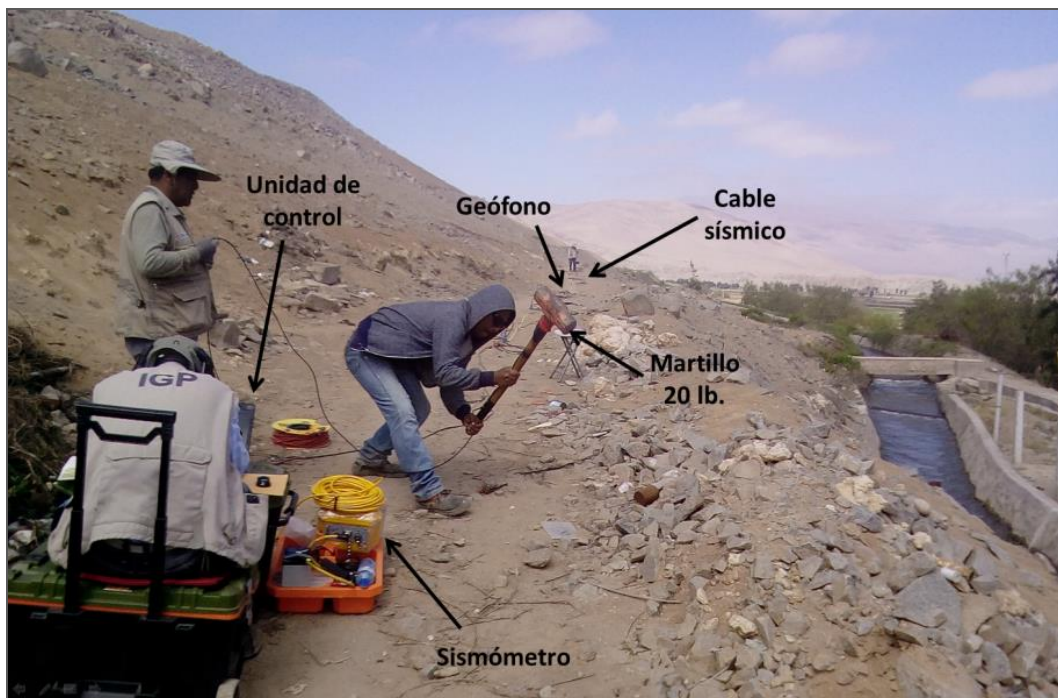
Figura 8. Equipos utilizados en la toma de datos de MASW realizado en la Asoc. Los Ajizales.
