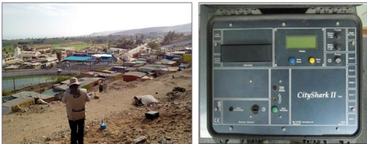
Figura 5: Equipo sísmico utilizado para el registro de vibraciones ambientales en Ite: sensores Lennartz (2N) y registrador CityShark II
