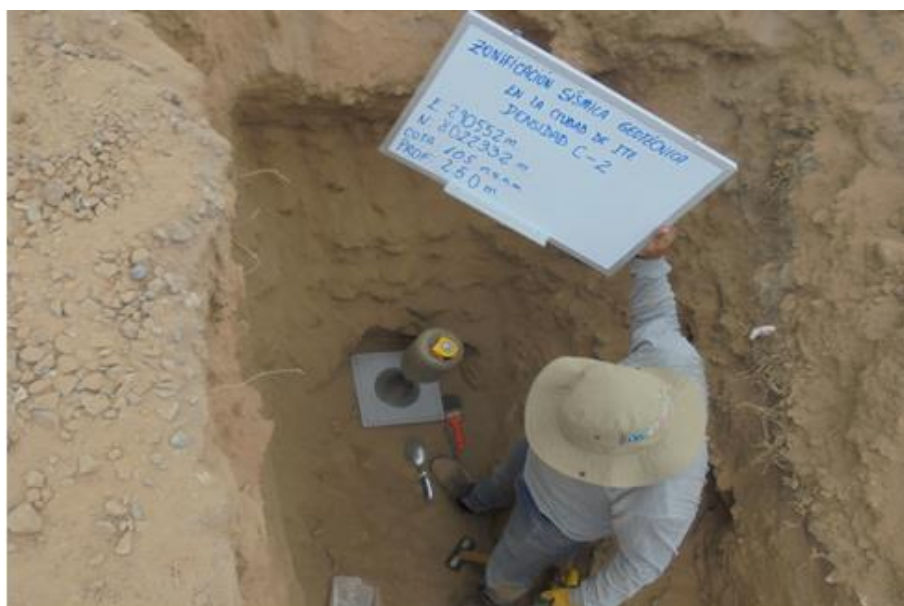
Figura 35: Ensayo de densidad del suelo in-situ en la calicata CI-02.
