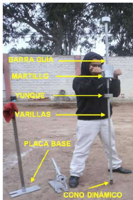
Figura 8: Equipos, accesorios y técnica de DPL
