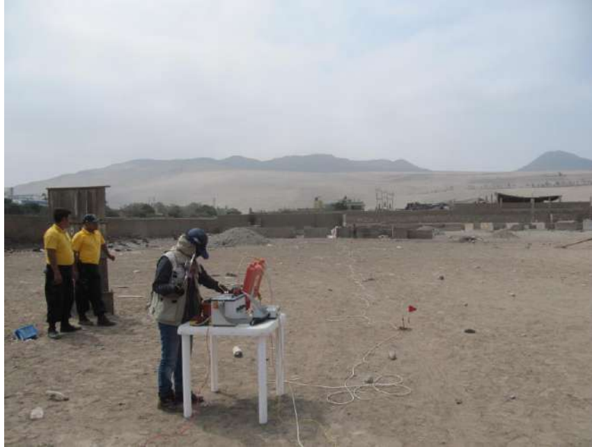
Figura 13: Disposición del equipo de prospección eléctrica en la ciudad de Asia
