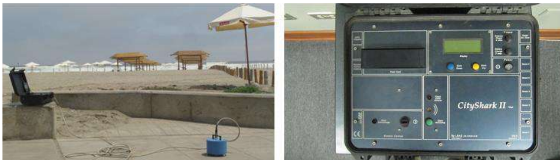
Figura 9: Equipo sísmico utilizado para el registro de vibraciones ambientales en Asia: sensores Lennartz (2N) y registrador CitySharp
