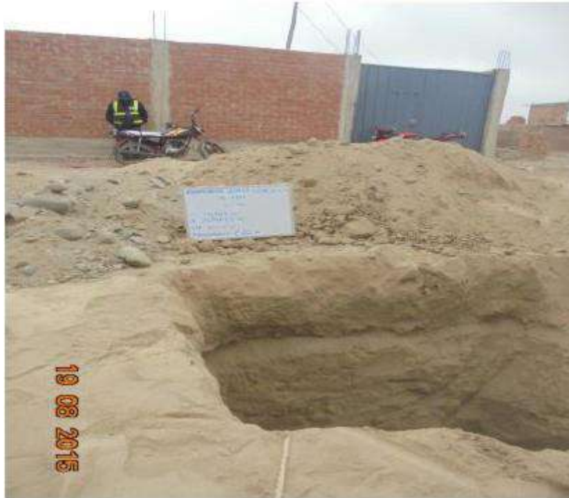
Figura 6: Calicata elaborada en el área urbana de Asia con el apoyo de la municipalidad. Extracción de muestras para conocer, por ejemplo, la densidad del suelo mediante el método del Cono de Arena.
