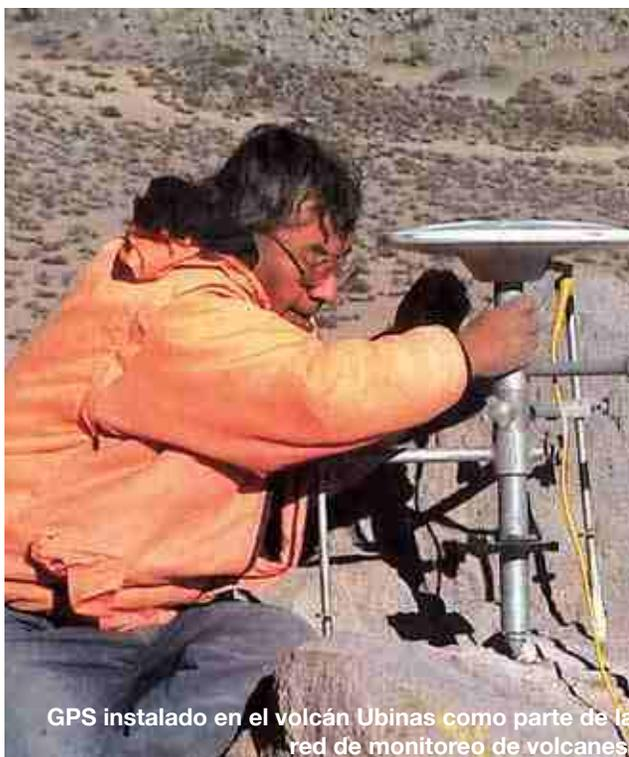
GPS instalado en el volcán Ubinas como parte de la red de monitoreo de volcanes
