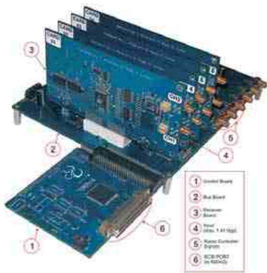
**Sistema de Adquisición JARS (Jicamarca Acquisition Radar System).**
