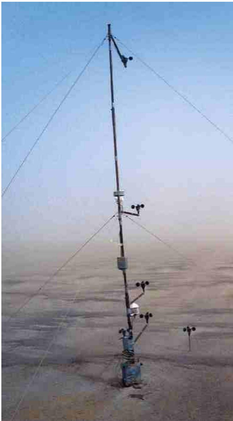
**Estación meteorológica WINDA en el desierto de Paracas. Seis anemómetros registraron la velocidad del viento en el preciso instante en el que se desarrolló la tormenta de polvo y arena (VIENTO PARACAS) a diferentes alturas del suelo, sujetos a un mástil de fierro de cuatro metros de altura.**
