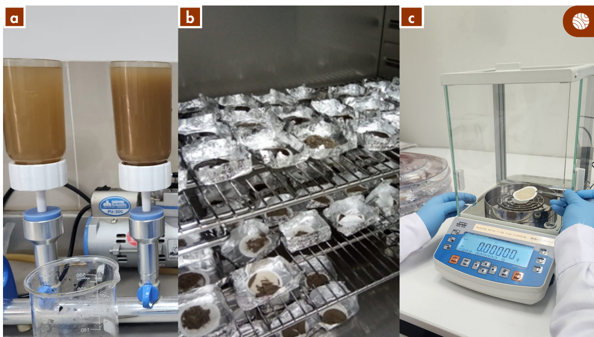
Figura 2.2.4. Procesamiento de matrices líquidas para el cálculo de concentración: a) sistema de separación de fases por filtración al vacío; b) deshidratación controlada de muestras; y c) pesaje analítico bajo estándares de precisión.
