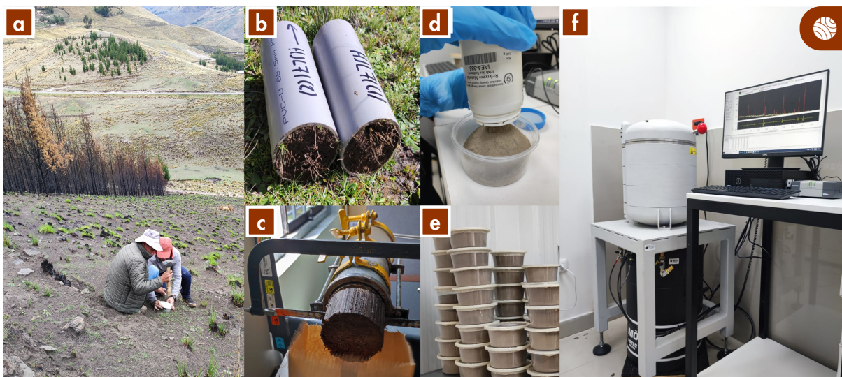
Figura 4.1.4. Proceso de extracción de testigos: a) extracción de testigos; b) testigos de suelo compuesto; c) laminado de testigos; d) acondicionamiento de muestra; e) muestras acondicionadas; y f) medición de muestras por espectrometría gamma.
