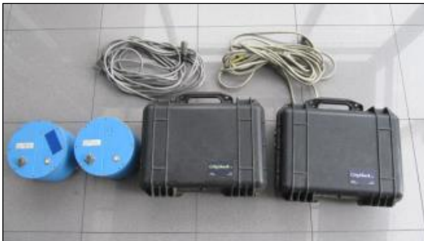
Figura 5. Equipo utilizado para el registro de vibración ambiental.
