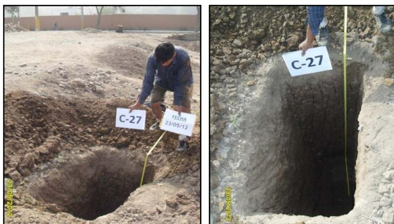
Figura C-27: Se observa la calicata tanto en superficie como en profundidad.
