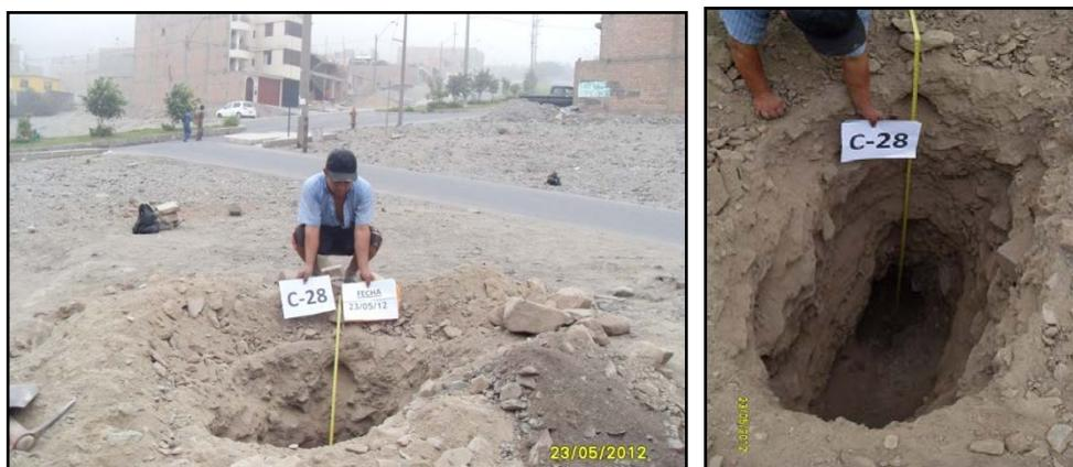
Figura C-28: Se observa la calicata tanto en superficie como en profundidad.
