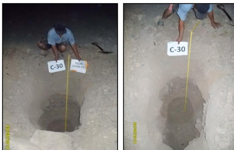
Figura C-30: Se observa la calicata tanto en superficie como en profundidad.
