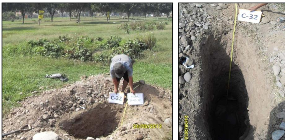
Figura C-32: Se observa la calicata tanto en superficie como en profundidad.
