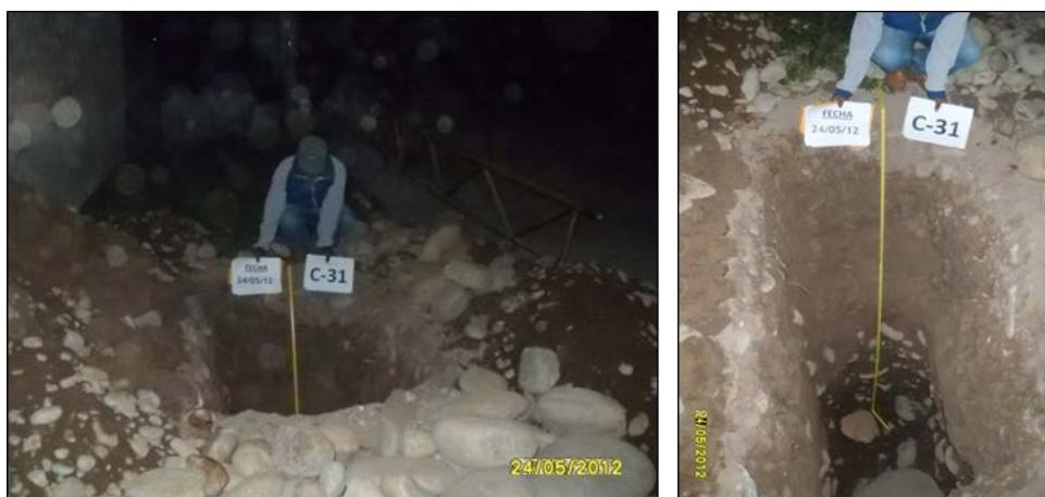
Figura C-31: Se observa la calicata tanto en superficie como en profundidad.
