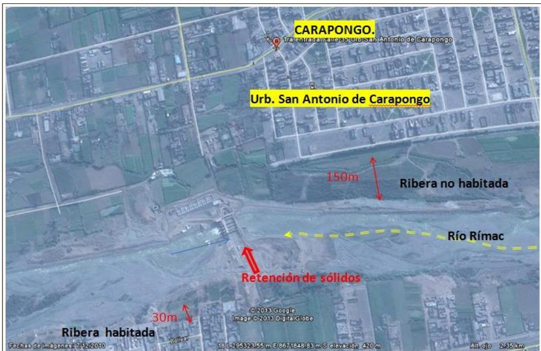
Figura 2.11: Obsérvese que la Urb. San Antonio de Carapongo se asienta a 150 m del lecho del río. Por otro lado, aguas abajo se observa que las viviendas han sido construidas a escasos 30 m del lecho, siendo estas últimas más susceptibles a peligros de inundación que las viviendas asentadas en la urbanización antes indicada.
