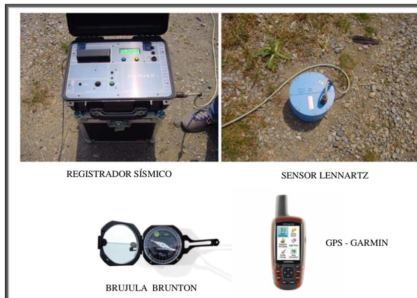
Figura 5.1: Equipo utilizado para el registro de vibraciones ambientales.
