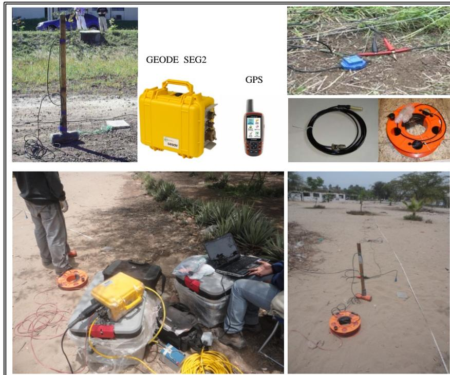
Figura 5.14: Equipos usados para la aplicación del método de refracción sísmica (MASW).
