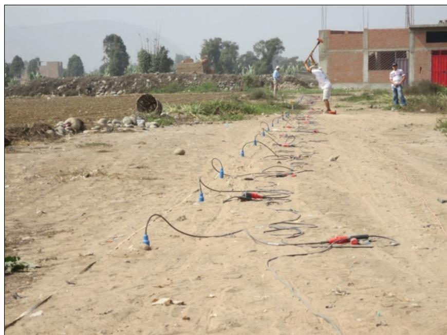
Figura 5.16: Imagen de la disposición del equipo de refracción sísmica para la toma de datos.
