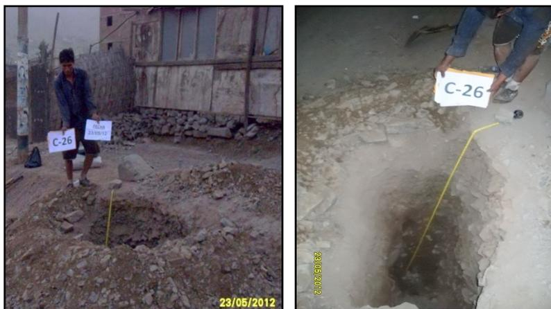
Figura C-26: Se observa la calicata tanto en superficie como en profundidad.
