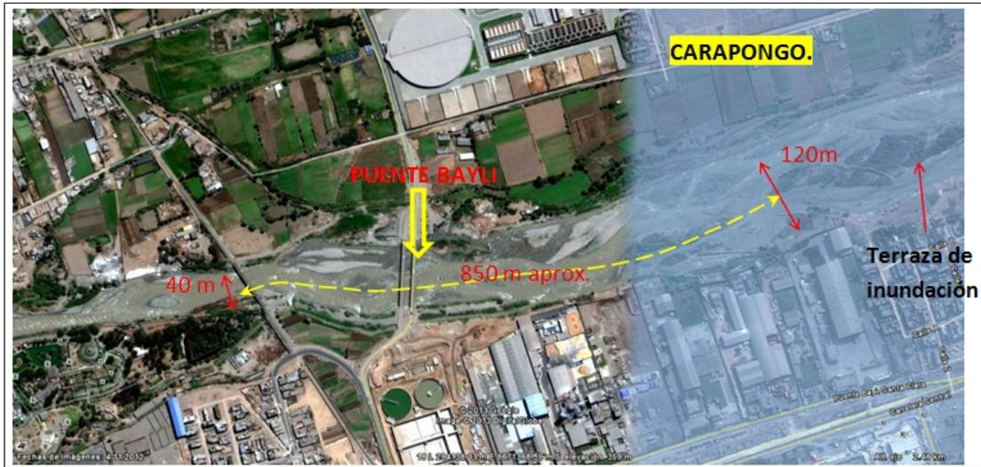
Figura 2.10: En la imagen se diferencian dos sectores, aguas arriba y aguas abajo del puente tipo Bayli. El primero presenta un cauce amplio; mientras que, el segundo el cauce es estrecho. Este último, por su morfología considerada a un área susceptible al desbordamiento del río.
