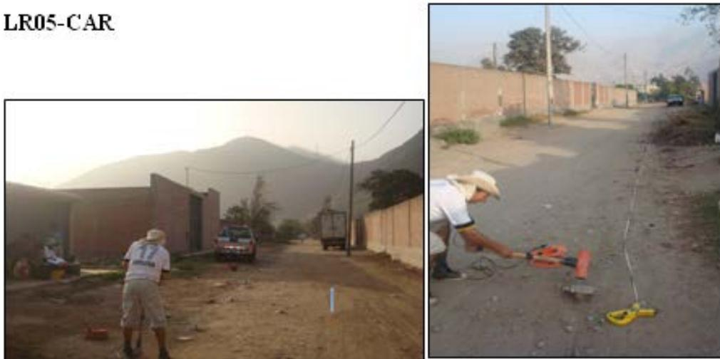
*Figura 5.19: ///Continuación... Imágenes de la disposición del equipo de refracción sísmica para la toma de la data.*
