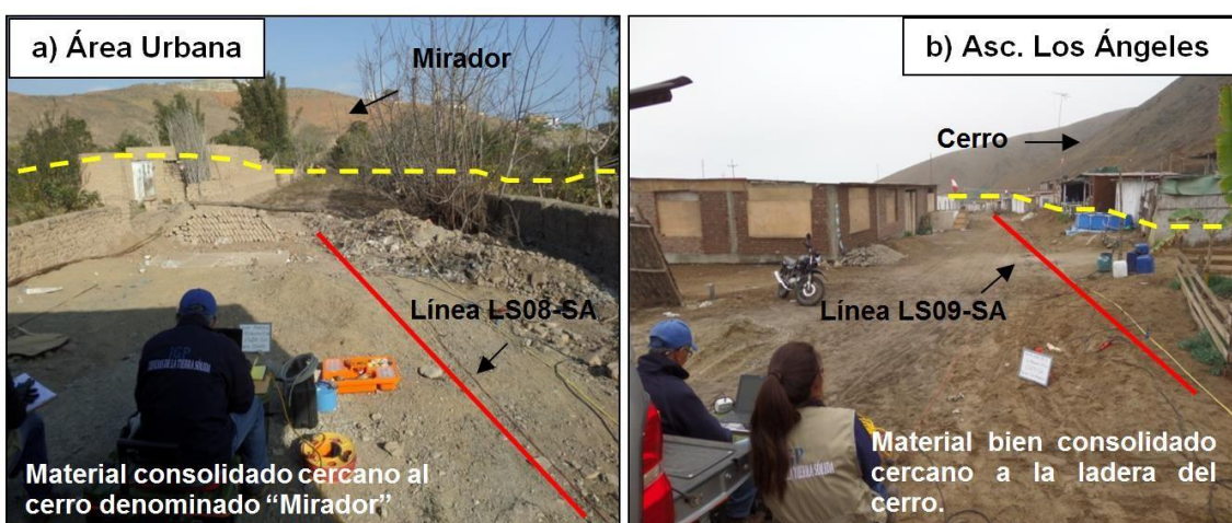
Figura 17: Ensayo sísmico realizado en el área urbana de San Antonio: a) capa superficial constituida por suelo medianamente rígido (LS08-SA) y b) suelo rígido (LS09-SA).
