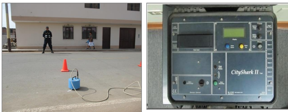
Figura 5: Equipo sísmico utilizado para el registro de vibraciones ambientales en San Antonio: sensores Lennartz (2N) y registrador CityShark II
