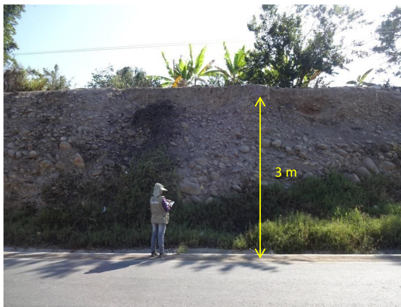
Figura 20: Gravas, arenas y arcillas que conforman la terraza aluvial en el sector Los Quintos
