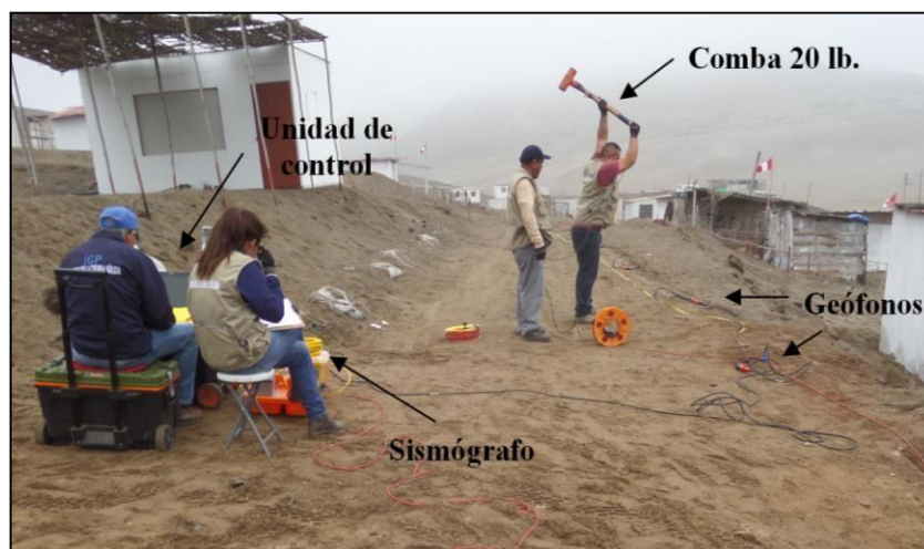
Figura 9: Equipos utilizados en la toma de datos de MASW realizado en el Jirón Daniel A. Carrión.
