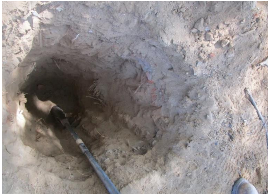
Figura 9: Depósito aluvial constituido por clastos redondeados en matriz arenosa de grano grueso a fino con algunos lentes de limos.
