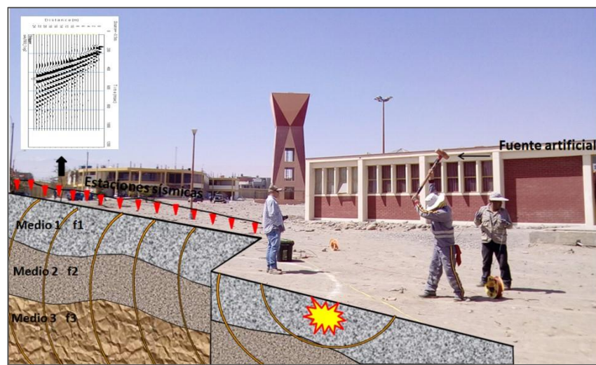
Figura 2: Generación de ondas Rayleigh con fuente artificial y su respectiva curva de dispersión.
