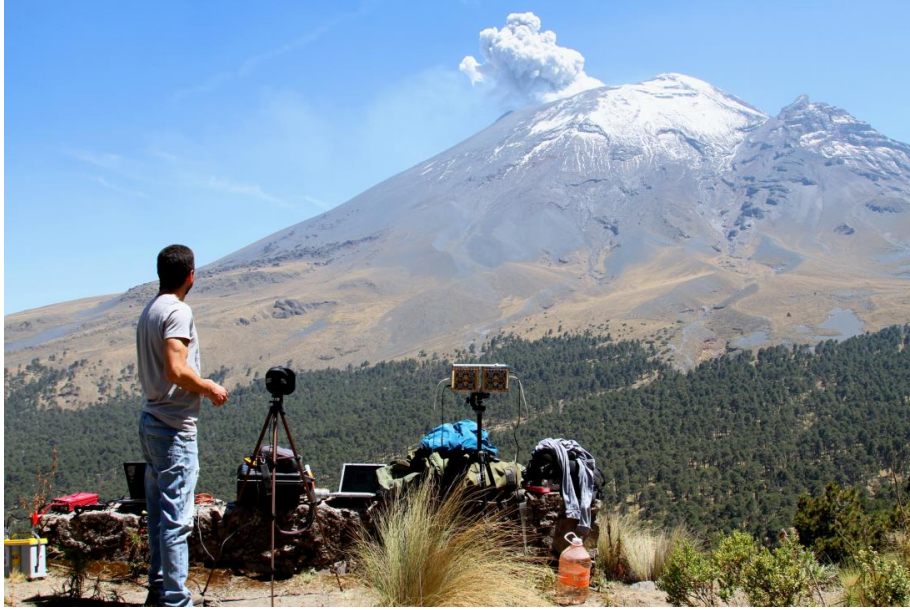
Figura 1. Mediciones geofísicas mediante equipos de cámara UV y Multigas, en el volcán Popocatepetl.
