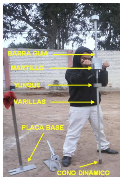
Figura 27: Equipos y accesorios que conforman el DLP.
