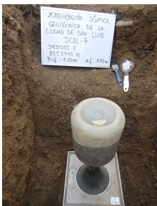
Figura 25: Densidad de campo, a través del Método del cono de arena, realizado en la Calicata C-07
