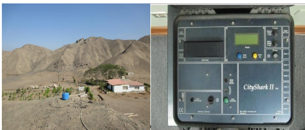
Figura 5: Equipo sísmico utilizado para el registro de vibraciones ambientales en San Luis: sensores Lennartz (2N) y registrador CityShark II
