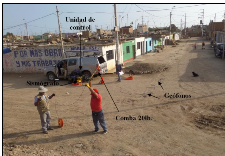
Figura 9: Equipos utilizados en la toma de datos de MASW Ubicado en UPIS Nuevo San Luis.
