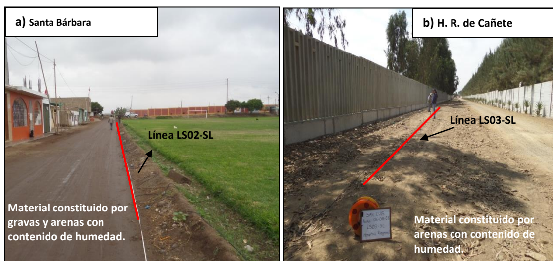
Figura 19: Ensayo sísmico realizado en el distrito de San Luis: a) capa superficial constituido por suelos blandos (LS02-LS y LS03-LS).
