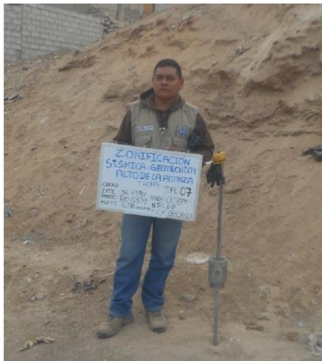
Figura 28: Ejemplo de ensayo de penetración dinámica ligera (DPL-07).
