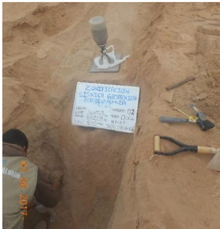
Figura 26: Ejemplo de ensayo de densidad del suelo in-situ en la calicata CAA-02.
