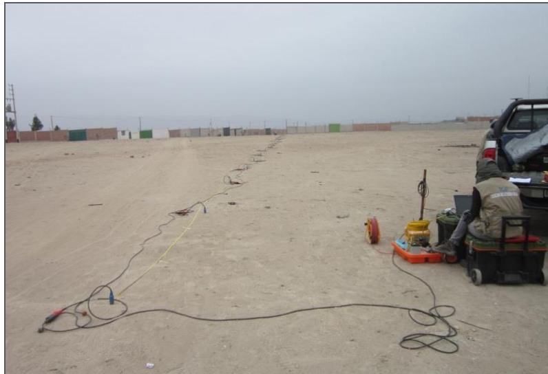
Figura 9: Equipos utilizados en la toma de datos de MASW en la zona industrial.
