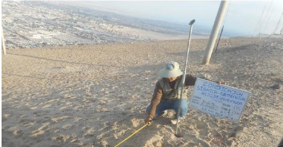
Figura 27: Ejemplo de ensayo con posteadora manual, posteado 05 en el área del mirador de Alto de la Alianza.
