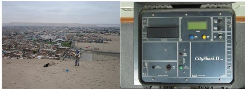
Figura 6: Equipo sísmico utilizado para el registro de vibraciones ambientales en Alto de la Alianza: sensores Lennartz (2N) y registrador CityShark II.
