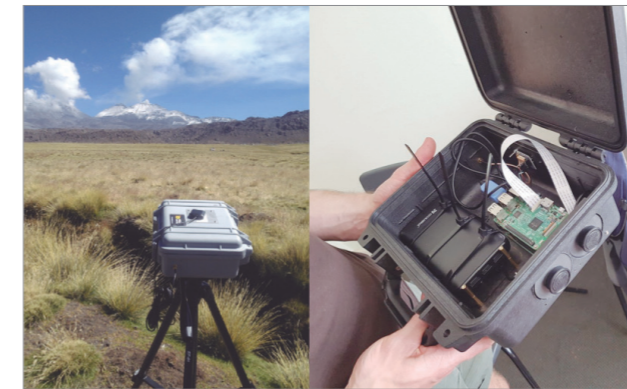
Figura 9.- Equipos DOAS adquiridos por el IGP en el marco del proyecto de "Mejoramiento y Ampliación del Sistema de Alerta Volcánica en el Perú."
