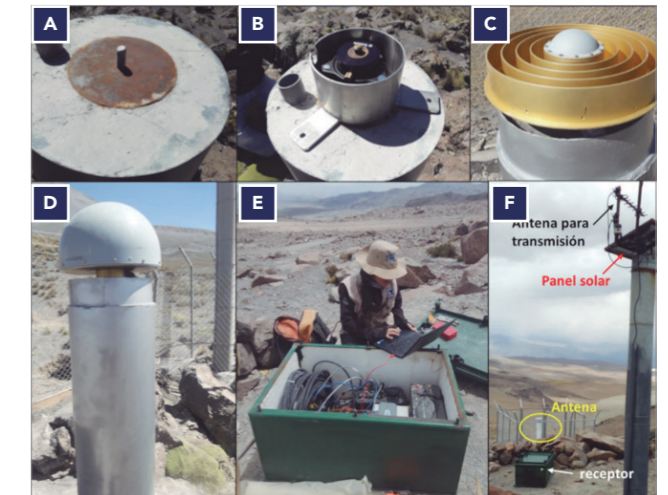
Figura 5.- Instalación de la estación GNSS: A) Monumento, B) base nivelante y ducto protector, C) antena, D) domo protector, E) configuración del receptor y F) estación completa GNSS.
