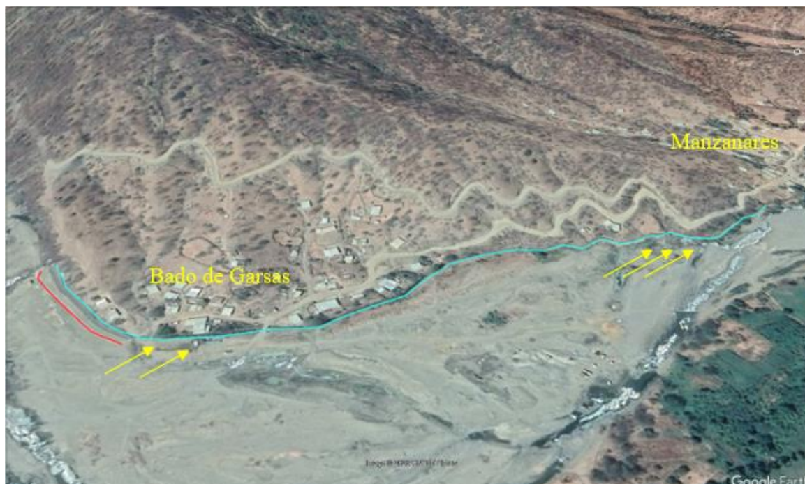
Figura 18.- Canal de irrigación Manzanares (línea celeste) ubicado entre los poblados Bado de Garzas y Manzanares asentado sobre una loma conformada por rocas del tipo filitas meteorizadas que presentan susceptibilidad alta a la ocurrencia de erosión fluvial (flechas amarillas principalmente) en su base (pie) y por tanto la infraestructura se encuentra expuesta a colapsos
