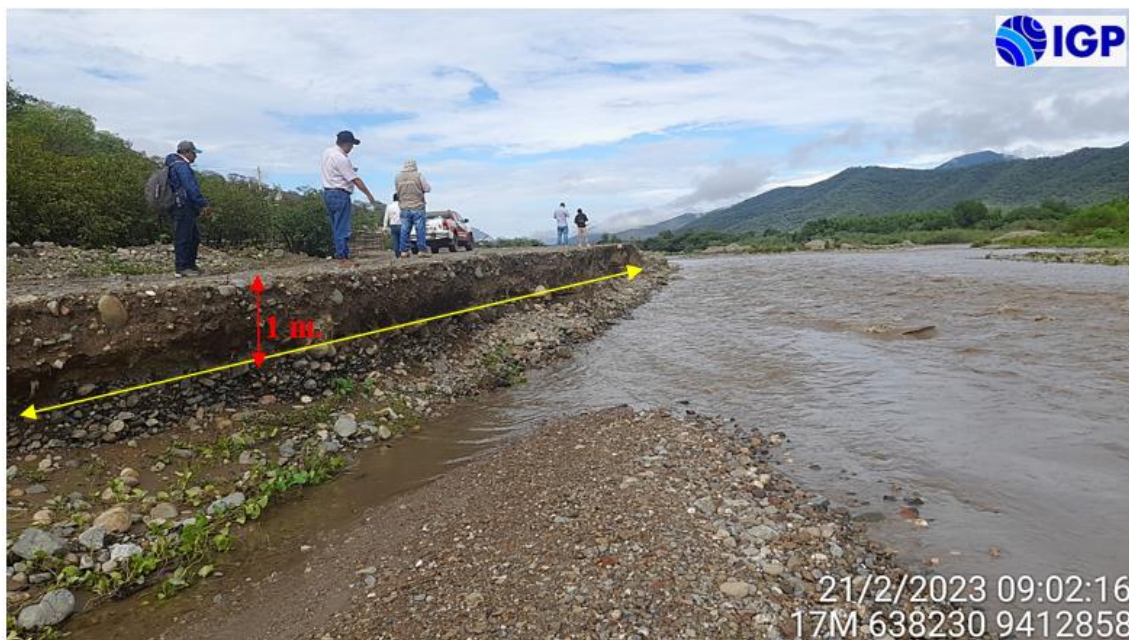
Figura 17.- Erosión fluvial (flecha amarilla) en el margen izquierdo del río Bigote donde las corrientes fluviales afectan la terraza aluvial conformado por gravas mal graduadas
