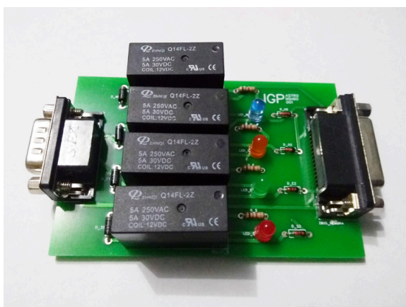
Figura 6: Interfaz IGP ASTRO NSH60 001, desarrollado en este trabajo y empleado en el autoguiado del telescopio NSH60 con la cámara CCD SBIG ST-7.
