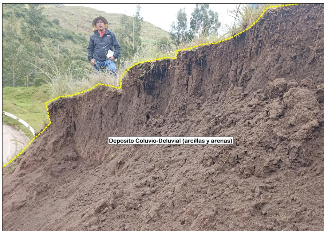
Figura 21.- Depósito de arcilla - arenosa de grano fino a medio, con matriz plástica, color rojizo en el Sector de Taparcalla.
