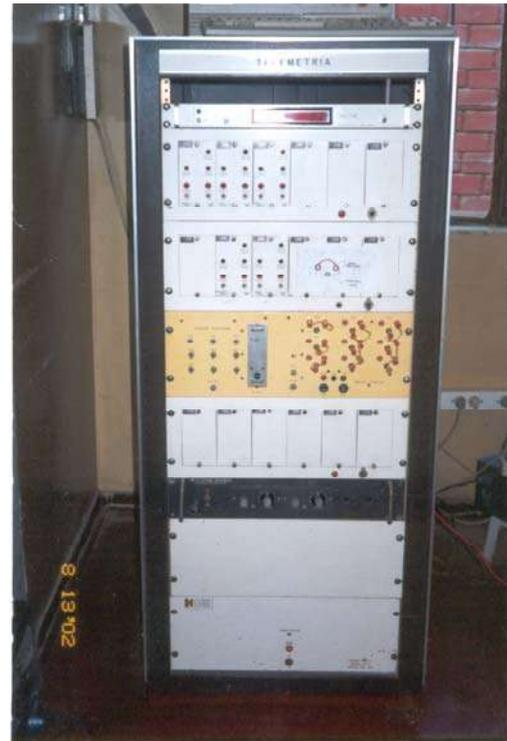
Figura 5. Gabinete de telemetría mostrando: Reloj Satélite, Discriminadores, Panel de Señales Portadoras, Panel de las Señales a la PC de adquisición de datos, Caja de conexiones y fuente de alimentación.
