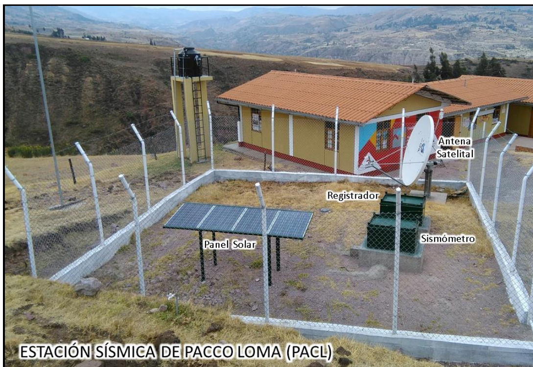
Figura 2.7; Componentes de la estación sísmica de Pacco Loma (PACL) de la Red Sísmica Nacional del Perú (Fuente IGP).
