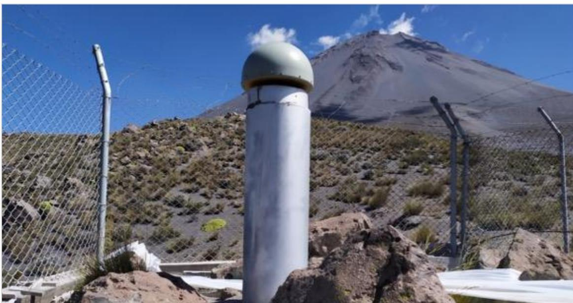
**Figura 5.-** Estación GNSS MS01 para monitoreo del volcán Misti.
