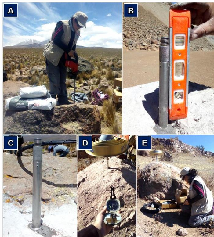
**Figura 23.-** Instalación de puntos de control geodésicos: A) taladrar la roca, B) marcador nivelado, C) secado del pegamento, D) antena apuntando al norte, E) configuración del equipo.
