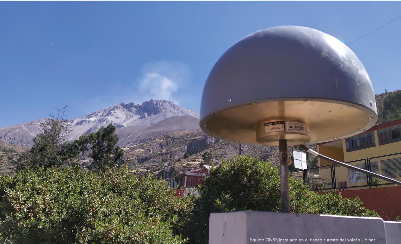
Equipo GNSS instalado en el flanco sureste del volcán Ubina
