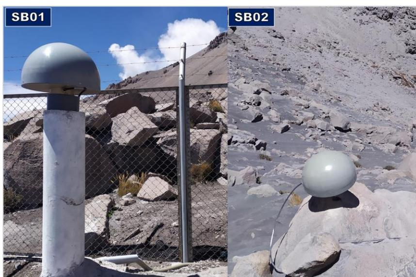
**Figura 9.-** Estaciones GNSS permanentes SB01 y SB02 ubicadas en los sectores norte y sureste del volcán Sabancaya, respectivamente.
