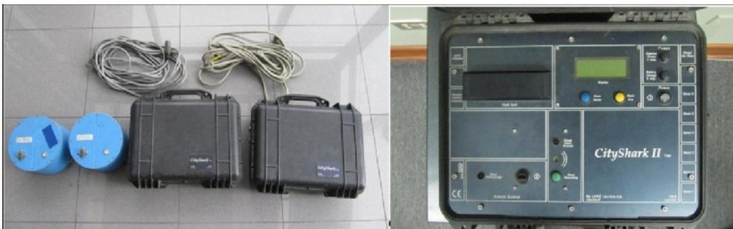
**Figura 6.8:** Equipo sísmico utilizado para el registro de vibraciones ambientales: sensores Lennartz (2N) y registrador CityShark.
