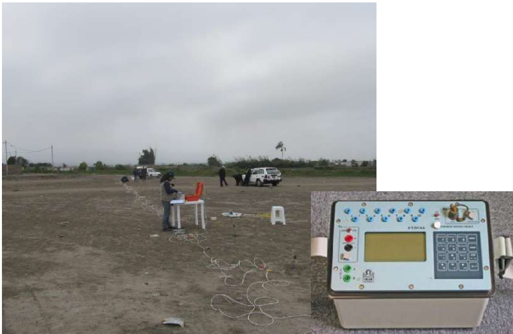
Figura 13: Imagen de disposición del equipo de prospección eléctrica para la toma de datos
