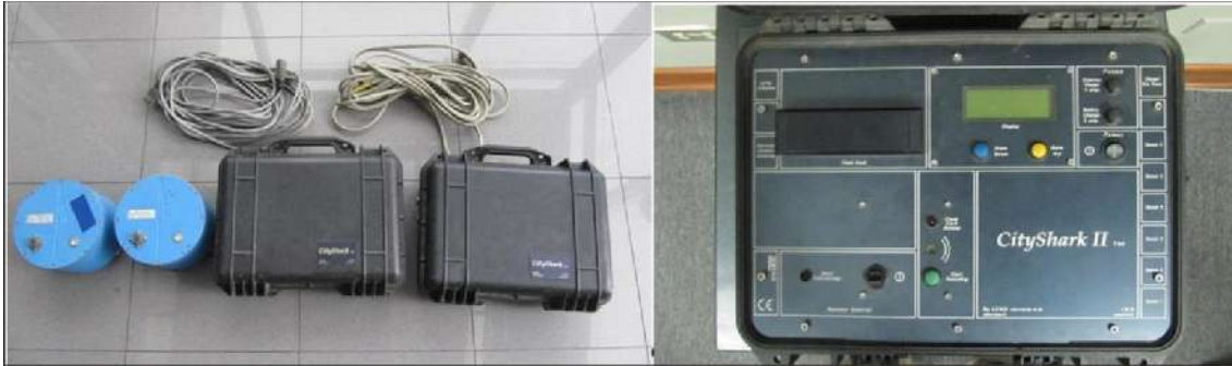
Figura 9: Equipo sísmico utilizado para el registro de vibraciones ambientales: sensores Lennartz (2N) y registrador CityShark
