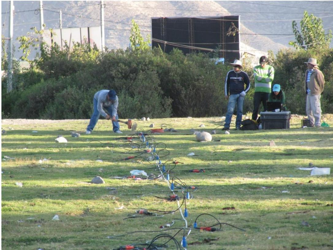
*Figura 4.17: Imagen de la disposición del equipo de refracción sísmica para la toma de data en el distrito de Sachaca.*
