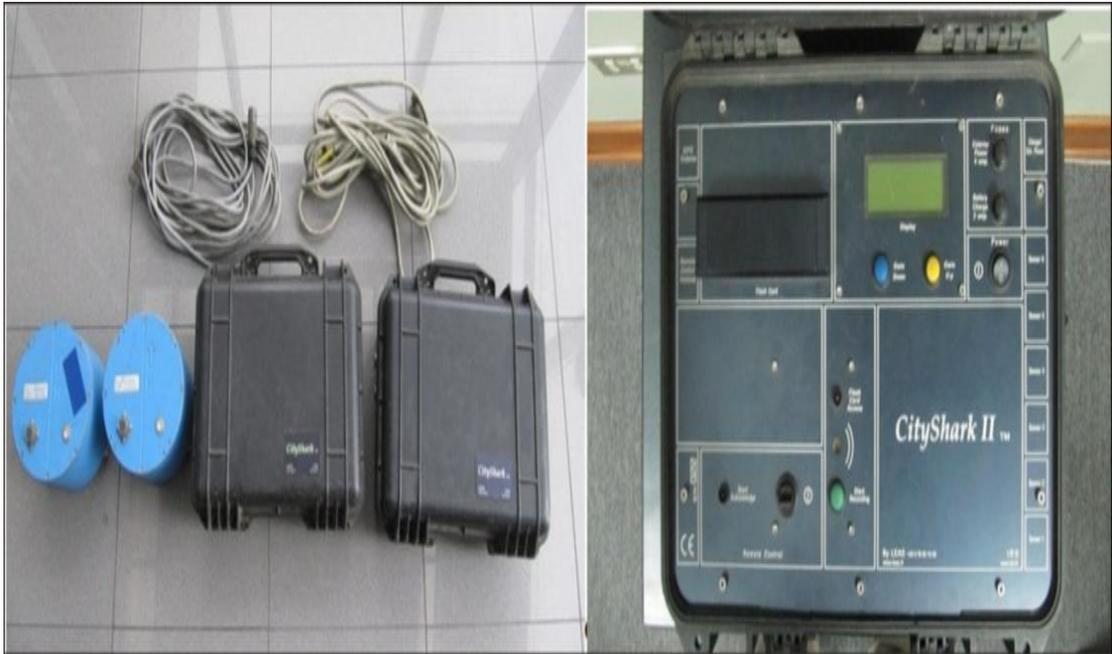
*Figura 4.13: Equipo sísmico utilizado para el registro de vibraciones ambientales: sensores Lennartz y registrador CityShark.*
