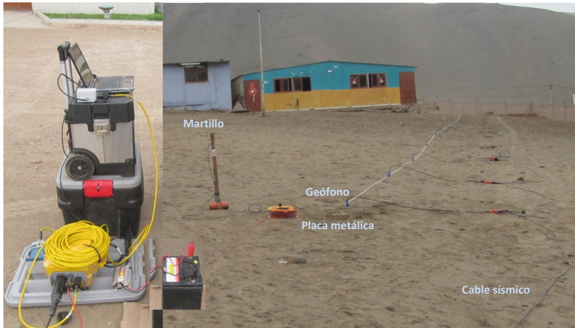
Figura 4.4. Instrumental utilizado en la toma de datos en la técnica de Análisis Multicanal de Ondas Superficiales (MASW): Línea LR03-SR.
