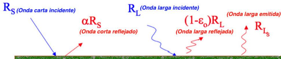
Figura 3.2: Balance de radiación de la superficie. Adaptado de Gordillo (2013)
