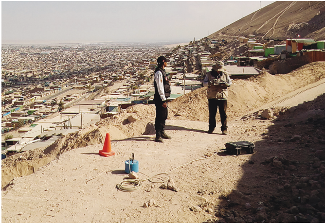
Adquisición de registros de vibración ambiental en Ciudad Nueva, Tacna.
