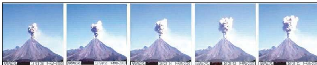
Figura 3.13 Vigilancia visual con una cámara de vídeo que permite obtener imágenes (Cada diez segundos) de la actividad del volcán (Observatorio Volcán de Colima)
