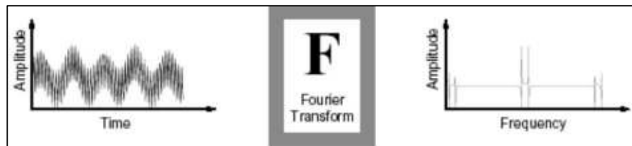
Figura 4.4 Esquema de la transformada de Fourier
