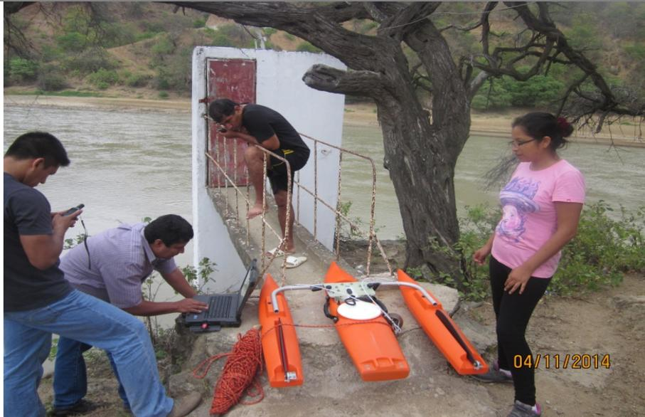
**Figura 63. Calibración de un equipo ADCP.**
