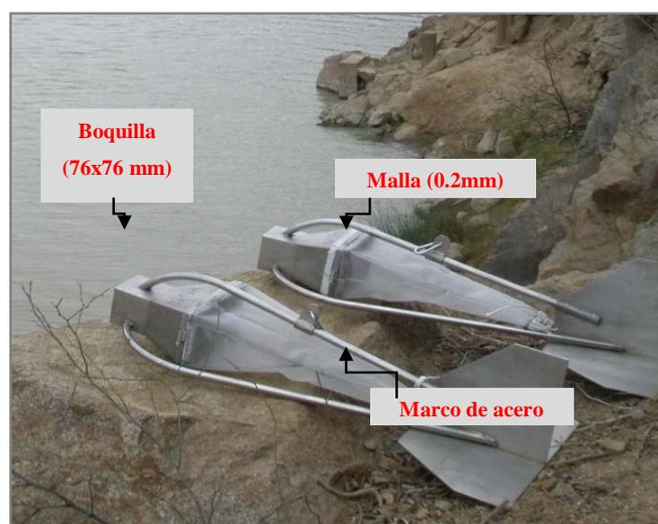
**Figura 30: Prototipos de muestreador de fondo Helley-Smith.**
