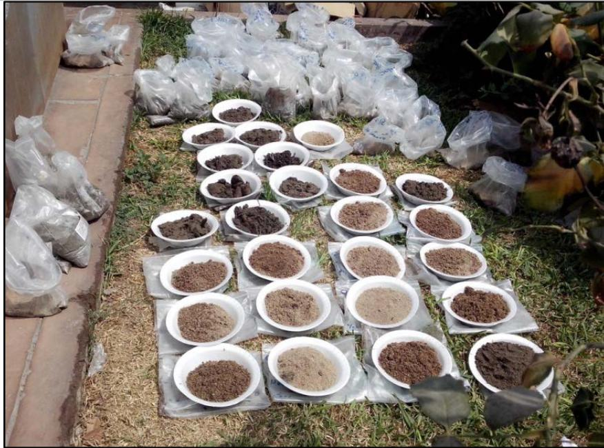
**Figura 68. Secado al ambiente de muestras de sedimento de fondo.**
