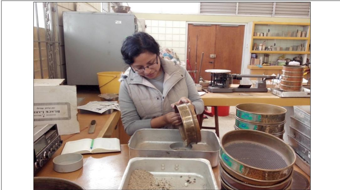
**Figura 71. Tamizado de muestras de sedimento de fondo.**
